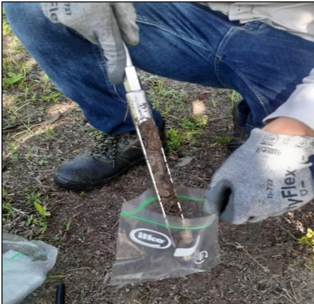
Figura 7A. Extracción de la muestra y colocación de la muestra en una bolsa hermética para ser llevada al laboratorio.
