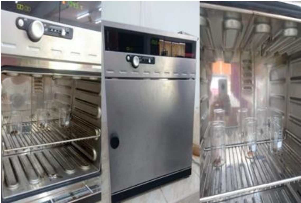
Figura 21A. Determinación de la humedad del boquichico ( Prochilodus nigricans A.).
