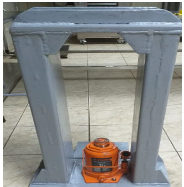
Figura 42. Prensa mecánica para la extracción de aceite
