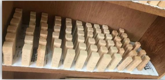
*Nota.* Luego de la toma de datos; todas las probetas fueron almacenadas en estante separados para que facilite la circulación del aire, en donde alcanzaron su condición de equilibrio.
