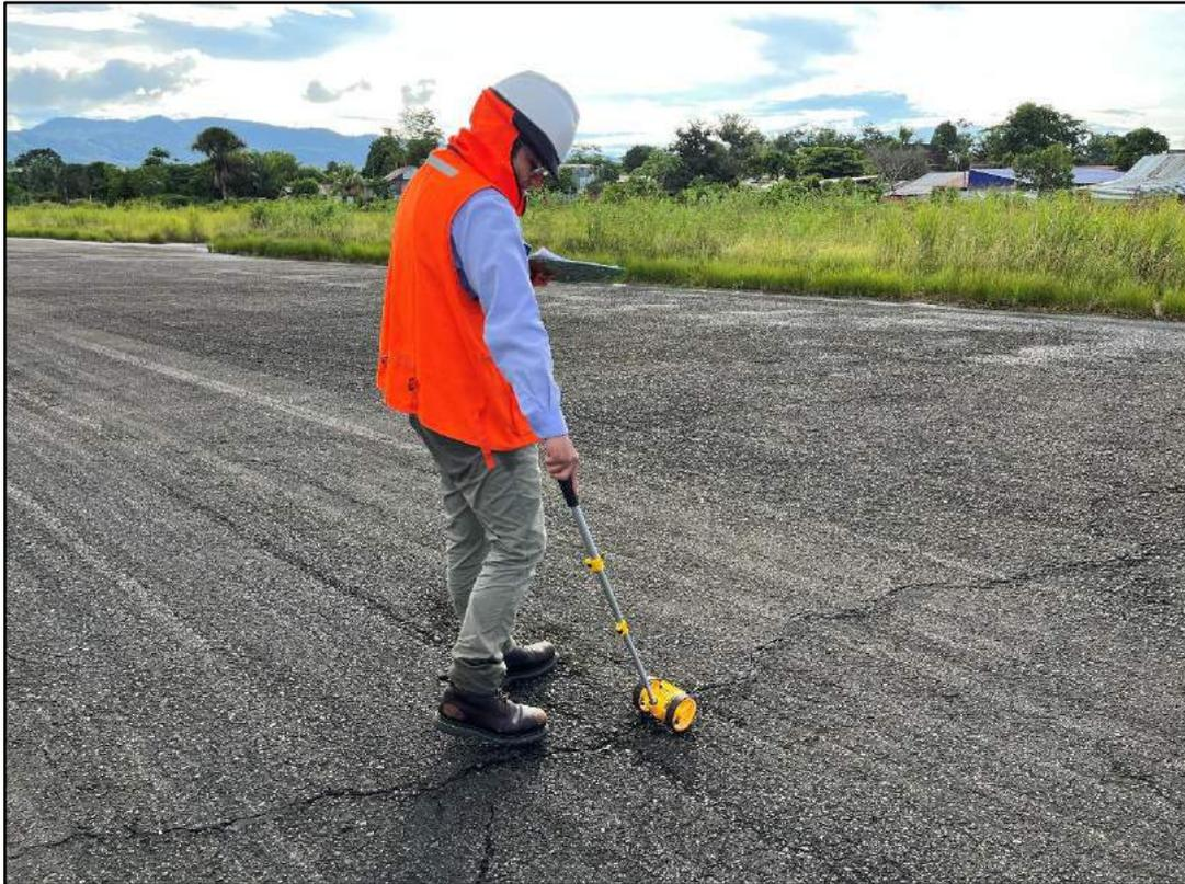
**Fotografía 33.** En la UM-10 tenemos una grieta donde se usó el odómetro para medirlo.
