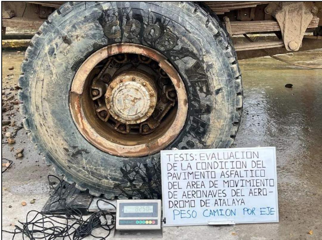
**Fotografía 5.** El peso del eje trasero del camión que aproximadamente es: 8200 kg.
