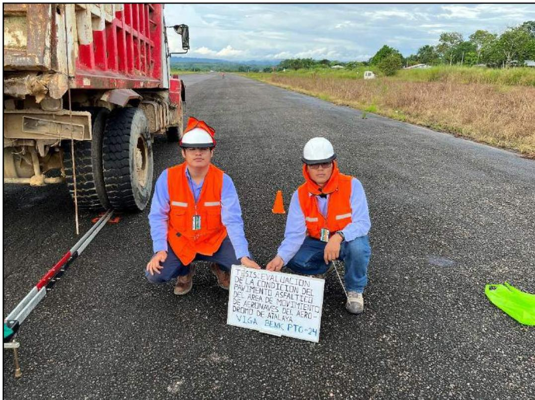
**Fotografía 14.** Pto. 23 – Ensayo de deflectometría con Viga Benkelman – Lado izquierdo Pista de aterrizaje.
