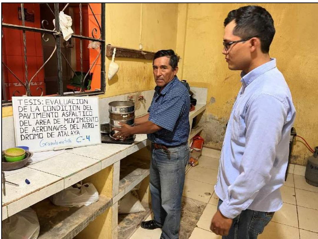
**Fotografía 42.** Ensayo de granulometría de la Calicata – 04.
