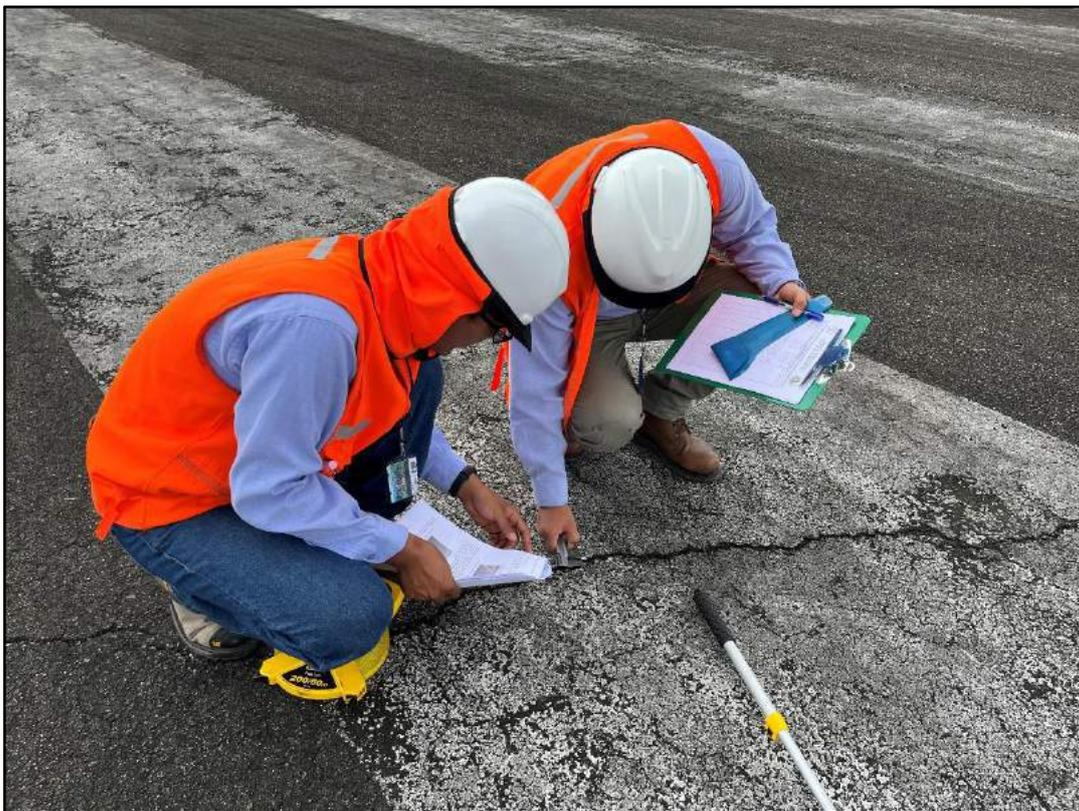
**Fotografía 32.** En la UM-01 se midió el espesor y profundidad de la grieta haciendo uso del vernier.
