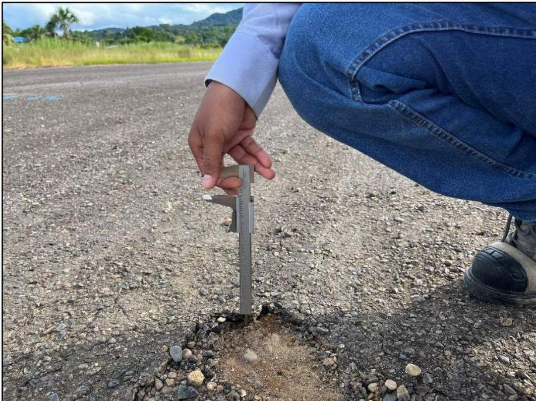
**Fotografía 36.** En la UM-52 se tiene falla Parcheo con severidad grave.
