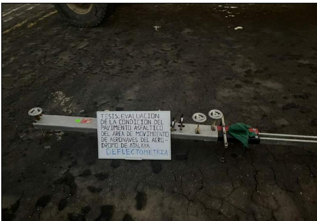
**Fotografía 2.** Viga Benkelman de dos brazos con relación 4:1.
