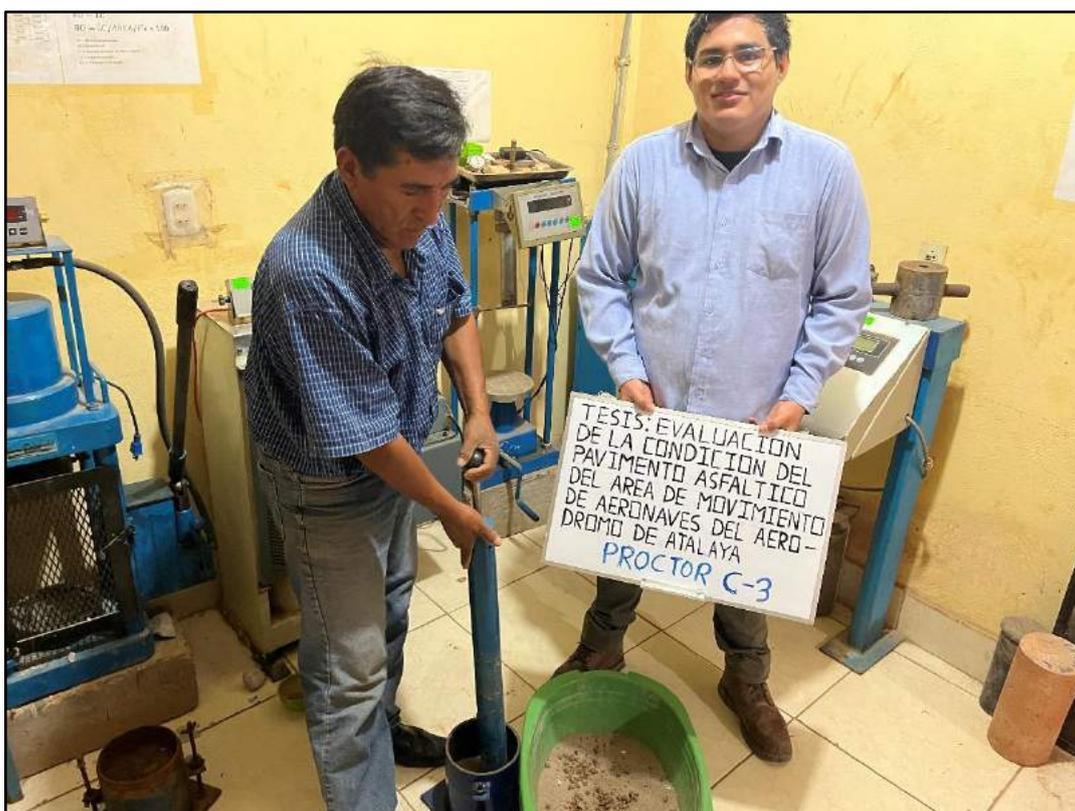
**Fotografía 50.** Ensayo de Proctor Modificado de la Calicata – 03.
