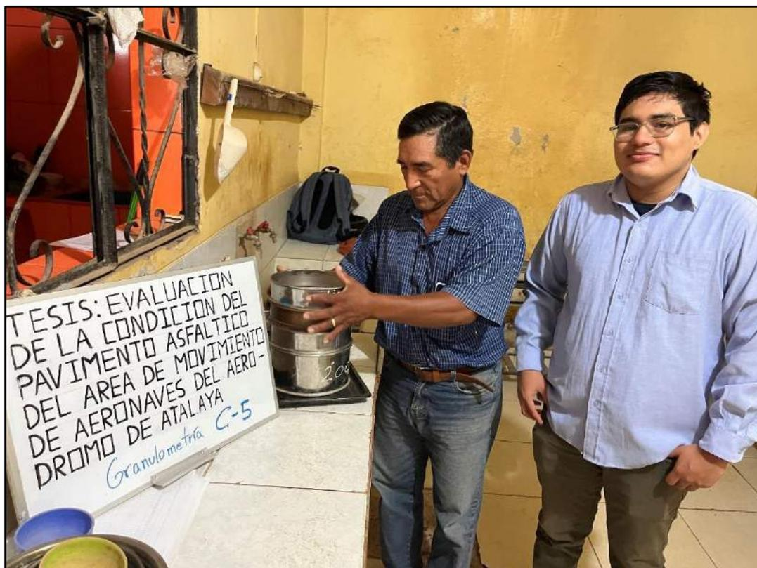
**Fotografía 43.** Ensayo de granulometría de la Calicata – 05.
