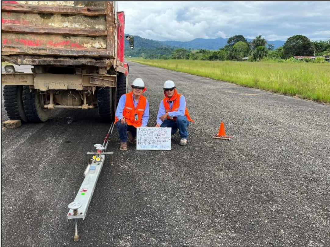
**Fotografía 9.** Pto. 04 – Ensayo de deflectometría con Viga Benkelman – Lado derecho Pista de aterrizaje.
