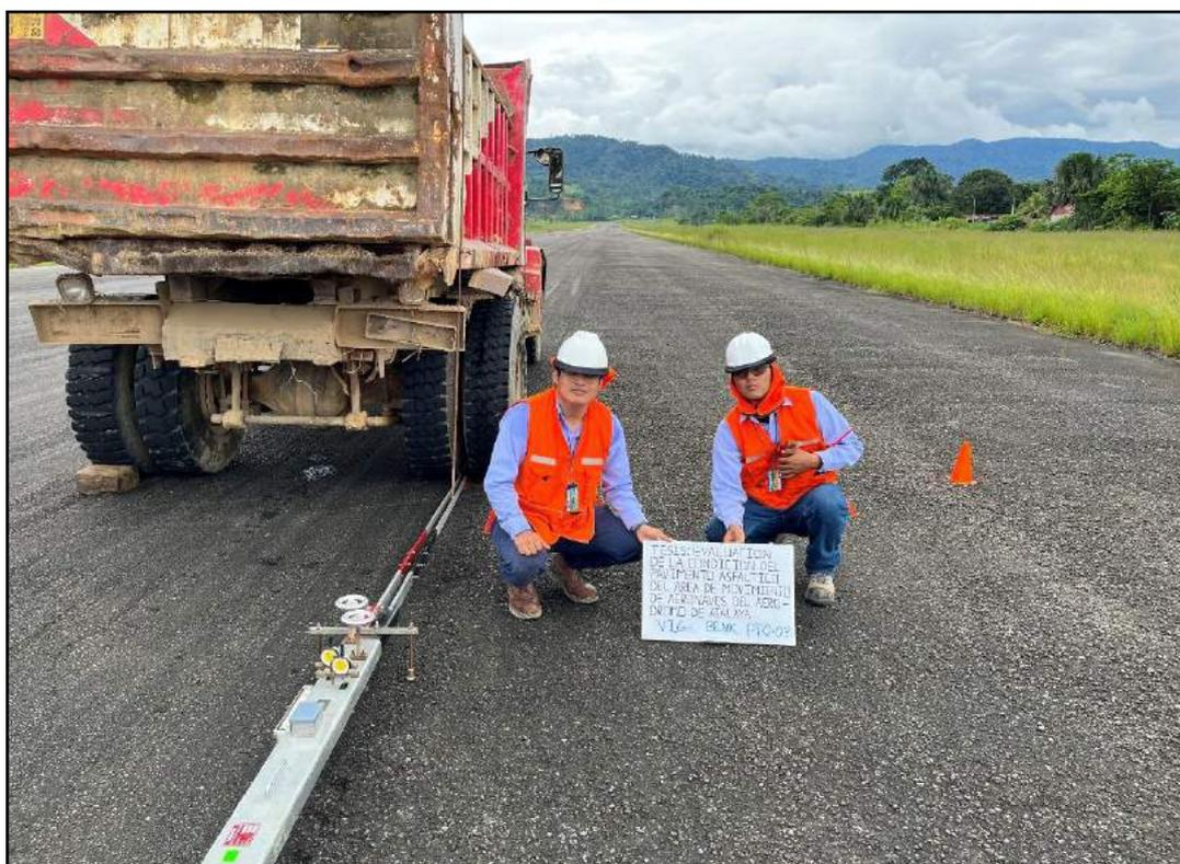
**Fotografía 8.** Pto. 03 – Ensayo de deflectometría con Viga Benkelman – Lado derecho Pista de aterrizaje.
