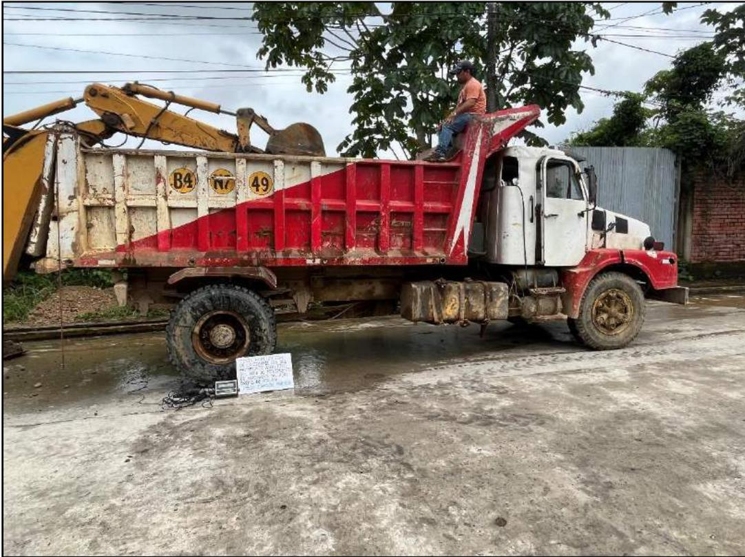
**Fotografía 3.** Camión que se utilizó para el ensayo de deflectometría.
