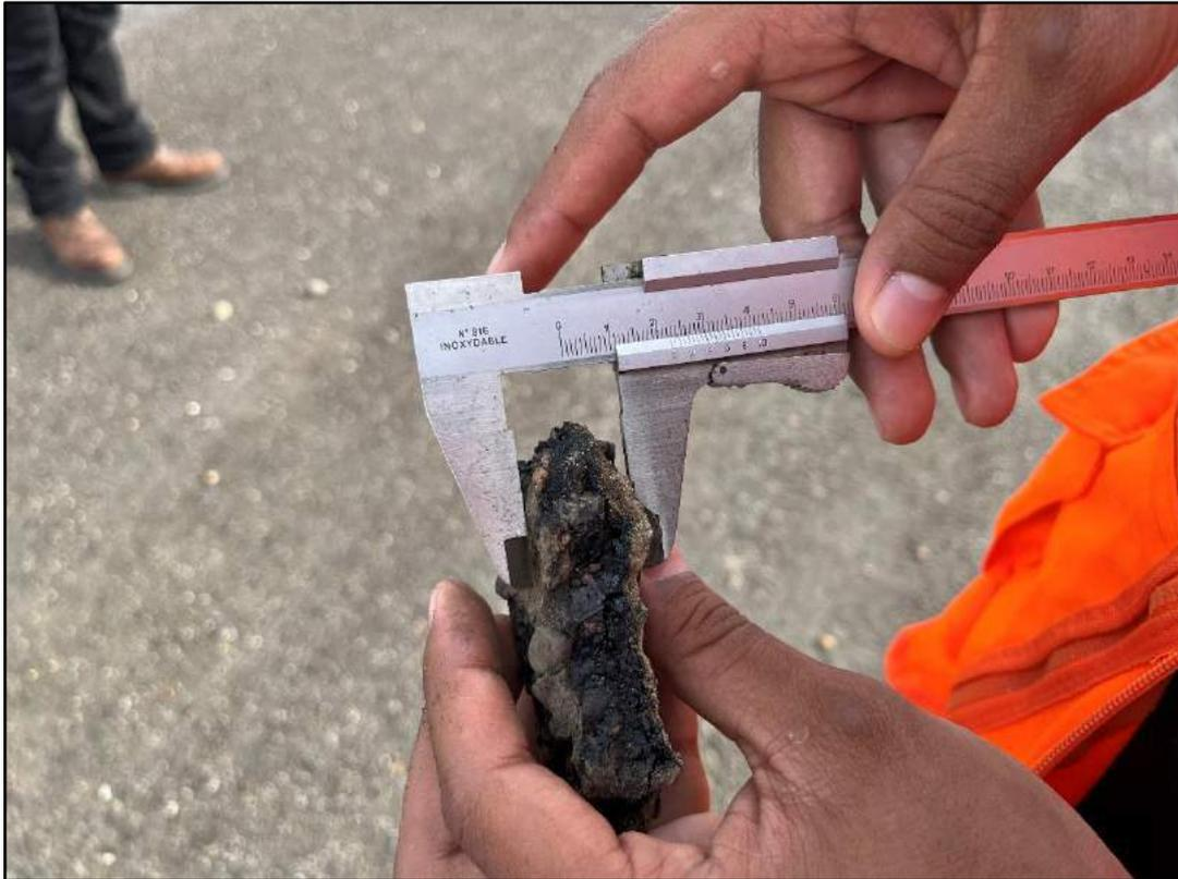
**Fotografía 37.** El espesor aproximado de la carpeta asfáltica es de 2 pulgadas.
