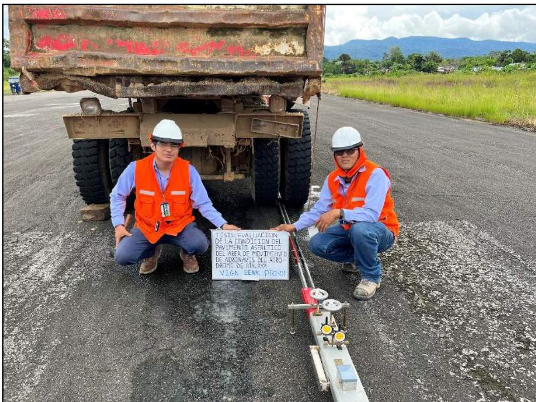
**Fotografía 6.** Pto. 01 – Ensayo de deflectometría con Viga Benkelman – Lado derecho Pista de aterrizaje.
