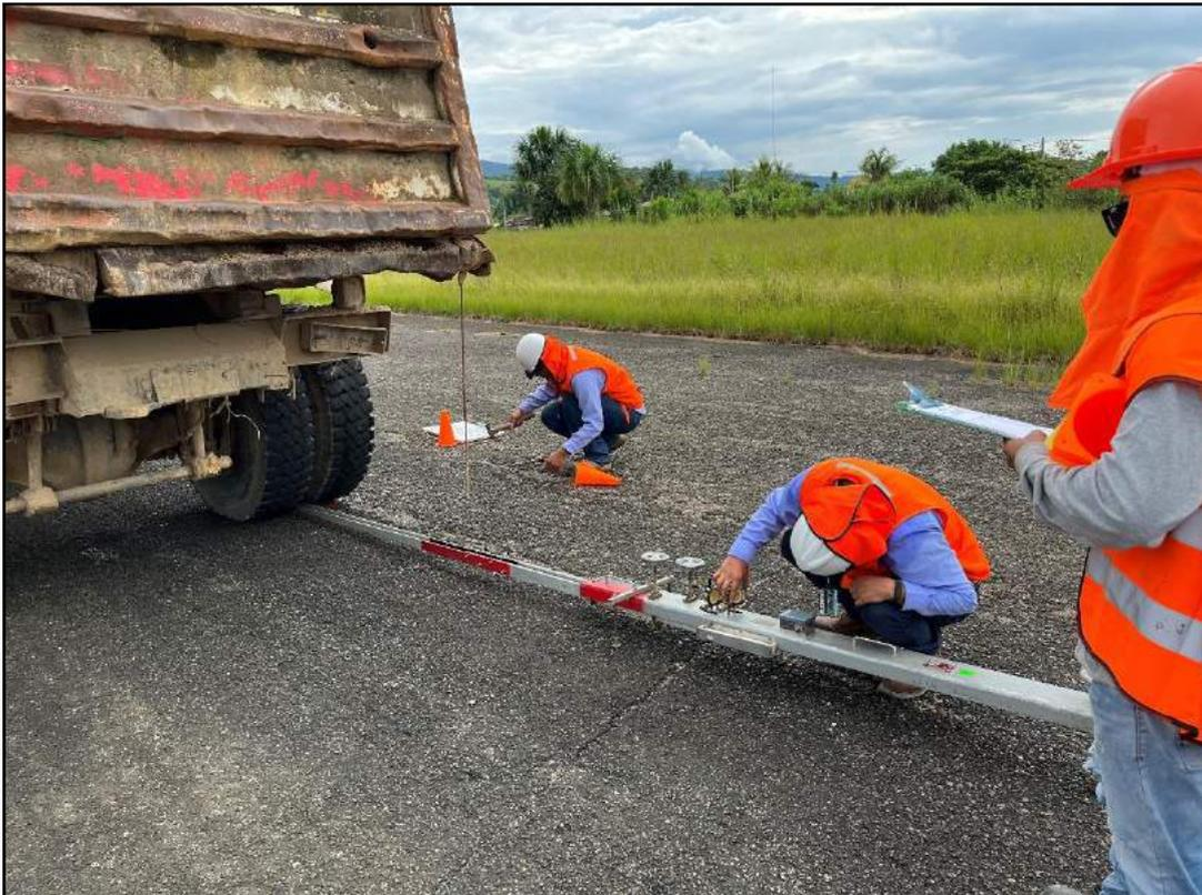
**Fotografía 10.** Medición de las deflexiones en campo con la Viga Benkelman.
