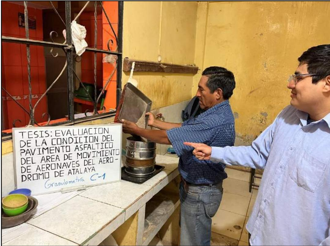
**Fotografía 39.** Ensayo de granulometría de la Calicata – 01.
