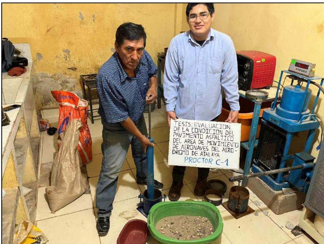
**Fotografía 49.** Ensayo de Proctor Modificado de la Calicata – 01.
