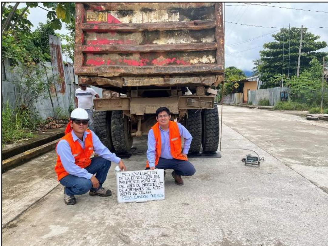
**Fotografía 4.** Pesaje del eje trasero del camión.
