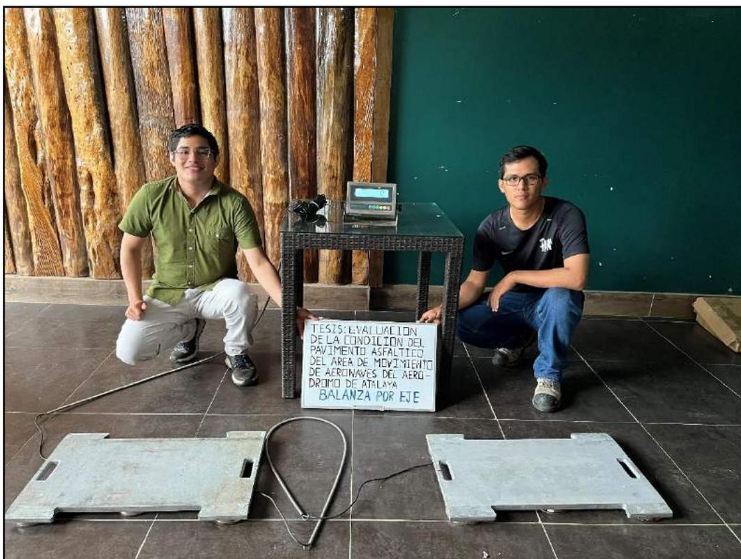
**Fotografía 1.** Balanza por eje modelo Axle Weight IV Portable.
