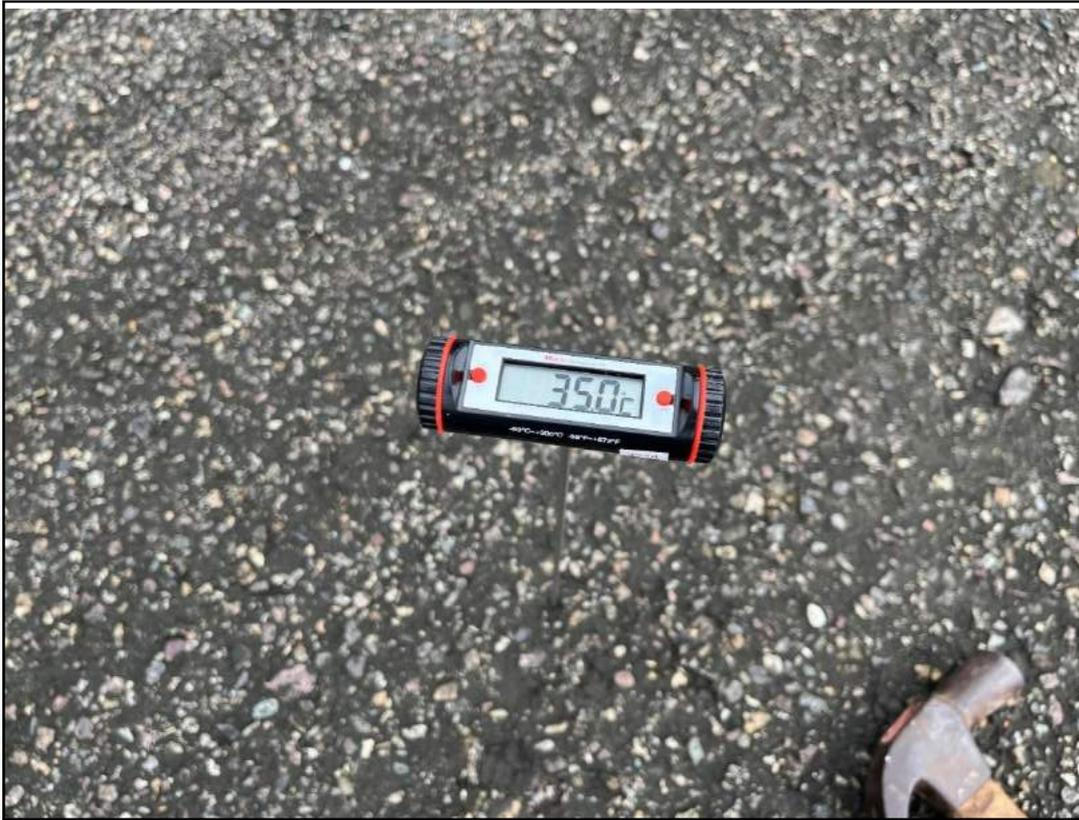
**Fotografía 11.** Medición de la temperatura del pavimento asfáltico.
