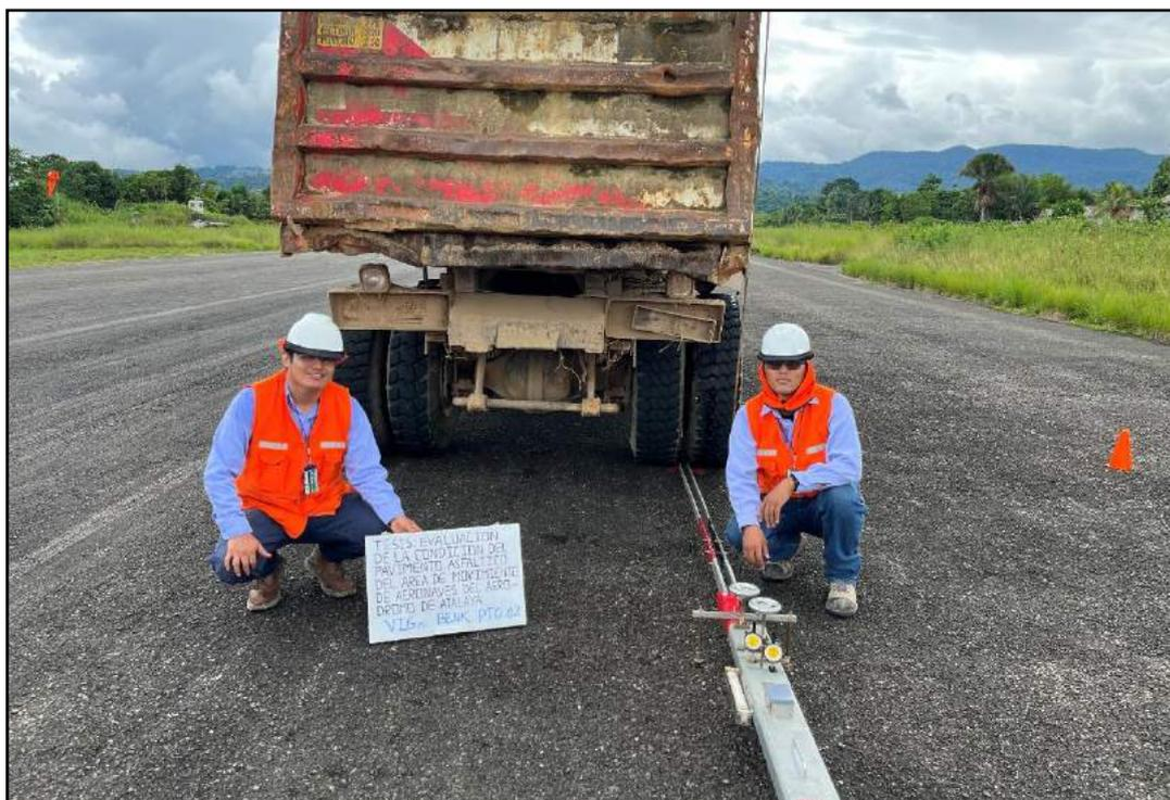
**Fotografía 7.** Pto. 02 – Ensayo de deflectometría con Viga Benkelman – Lado derecho Pista de aterrizaje.
