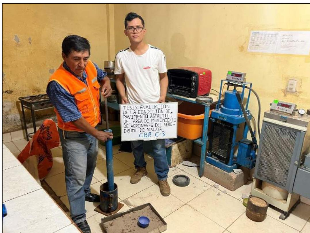
**Fotografía 52.** Ensayo de C.B.R. de la Calicata – 03.
