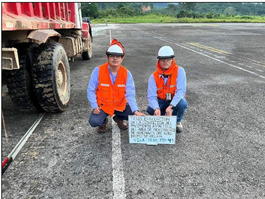
**Fotografía 17.** Pto. 41 – Ensayo de deflectometría con Viga Benkelman – Plataforma.
