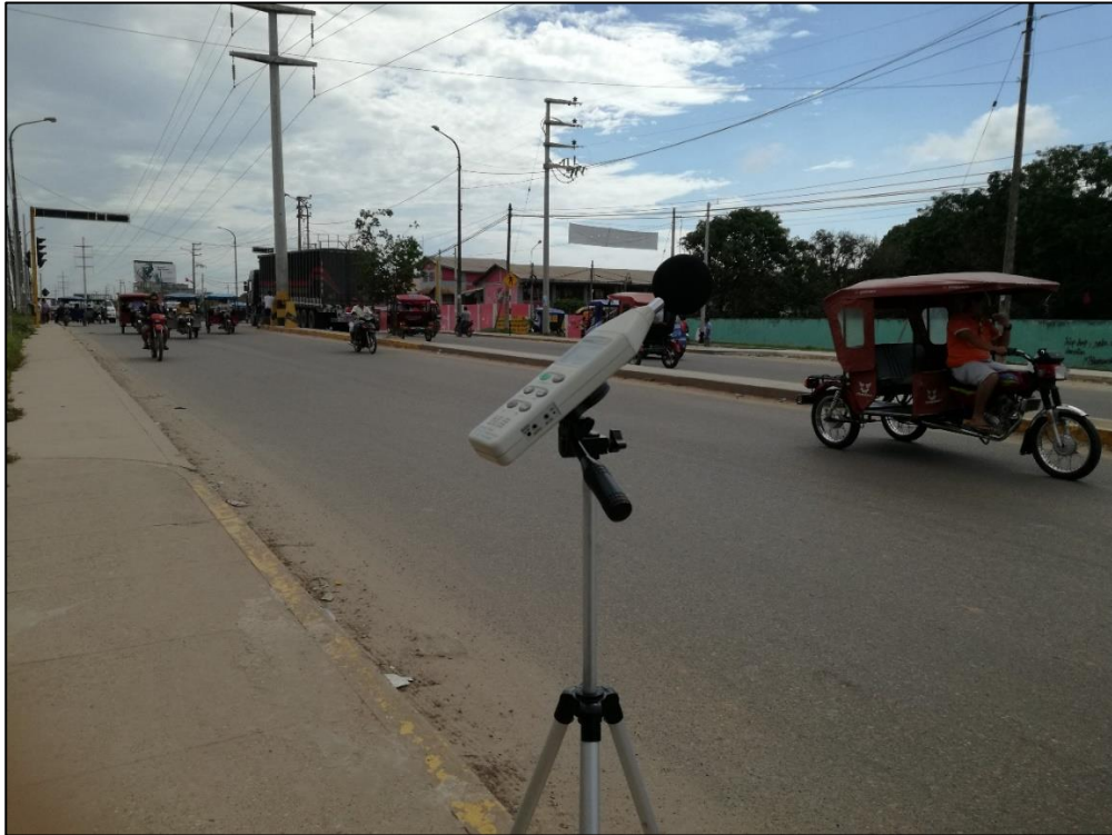
Figura 23. Monitoreo de ruido en el punto de muestreo de la Av. Centenario, km 3.700
