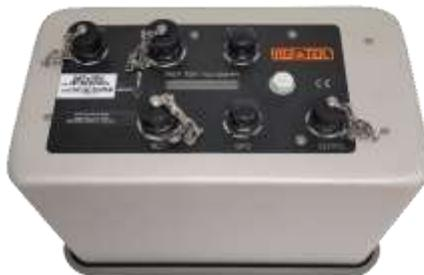
Mientras que la interfaz de comando y control en el sitio (software iFSC) y la pantalla LCD permiten una configuración rápida y comprobaciones de estado, las opciones de comunicación mejoradas incluyen TCP / IP a través de Ethernet y comunicación serie asíncrona. El conjunto de software RTI permite la configuración remota y la recuperación y el análisis avanzados de datos.
