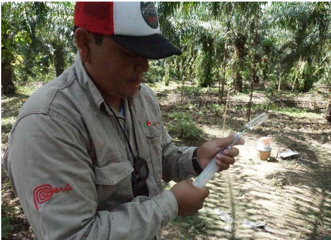
**Figura 27. Extracción del aire del vial para llevarlo al vacío.**
