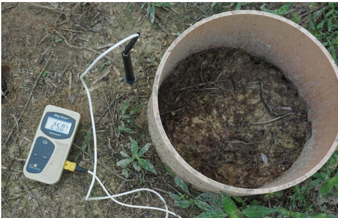
**Figura 23. Determinación de la temperatura del suelo, dentro del área experimental.**
