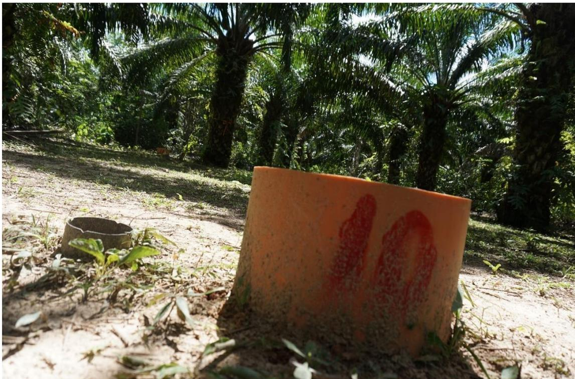
**Figura 25. Cámara estática listas para la extracción de gases de efecto invernadero.**
