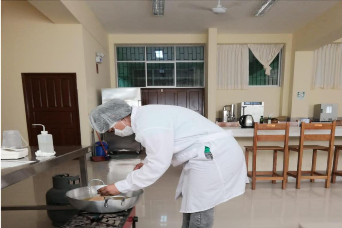
**Figura 11A. Proceso de concentración de la materia prima. Hasta llegar a los 65 °Brix.**
