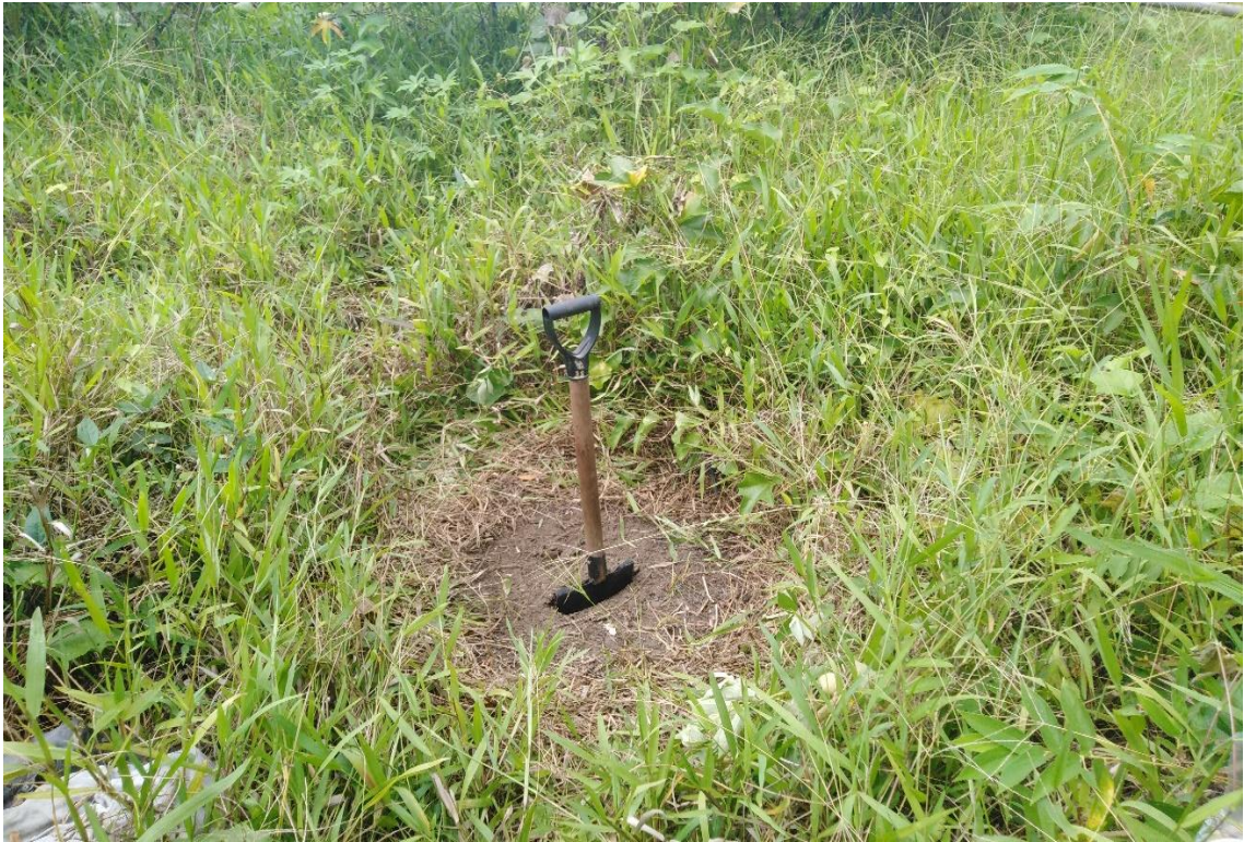
Figura 1A. Ubicación y limpieza del área donde se realizará la muestra de suelo.
