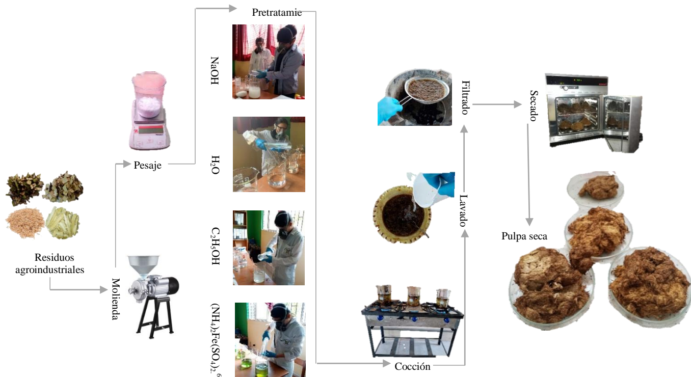
Figura 3. Proceso de deslignificación del bagazo de caña, cascarilla de arroz, cáscara de plátano y cáscara de yuca.
