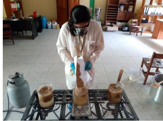
Figura 15. Tratamiento de cascarilla de arroz con agua destilada.
