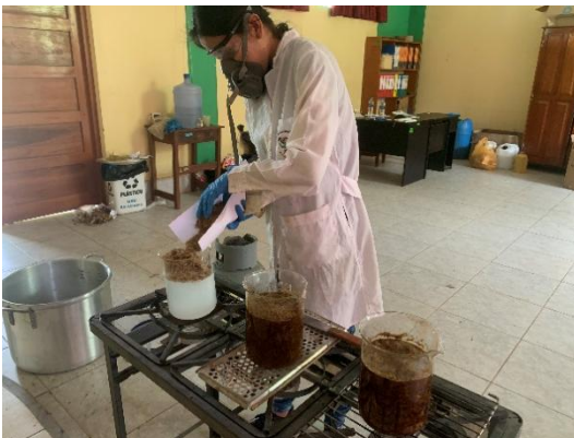
Figura 14. Tratamiento de bagazo de caña con NaOH.
