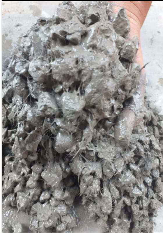
Imagen 11. Consistencia del Concreto permeable con incorporación de fibras de polipropileno.
