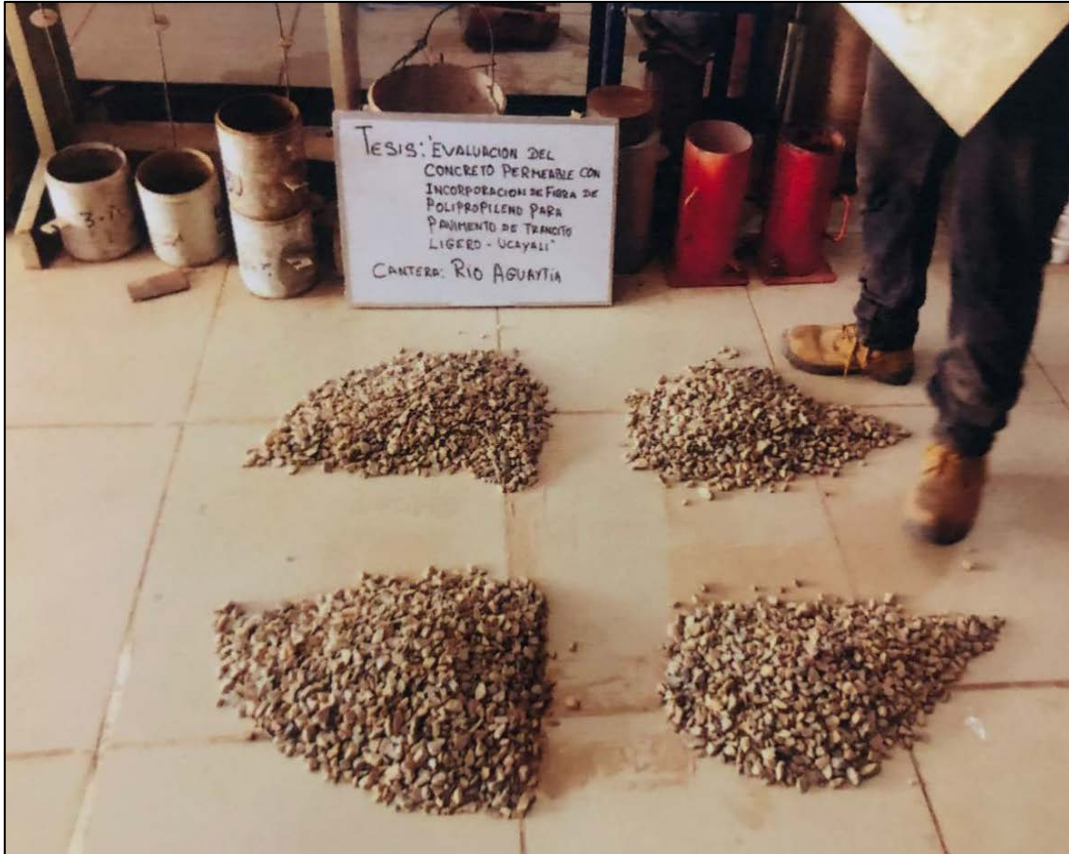
Imagen 5. Cuarteo de la muestra a usar para realizar los ensayos de laboratorio.
