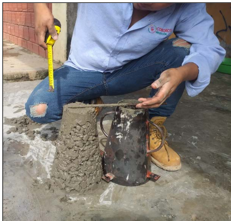
Imagen 10. Ensayo de Asentamiento, donde se observa cero Slump, propiedad característica de un concreto permeable.
