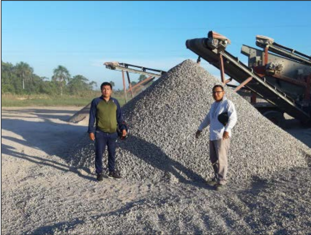
Imagen 1. Agregado grueso en su forma triturada \frac{3}{4} " de la planta Chancadora del Km 15.
