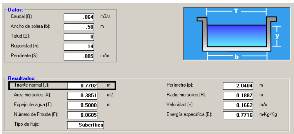
Figura 26. Cálculo de tirante de cuneta para un concreto permeable f'c=245 kg/cm 2 con 0.30% de fibras de polipropileno.
