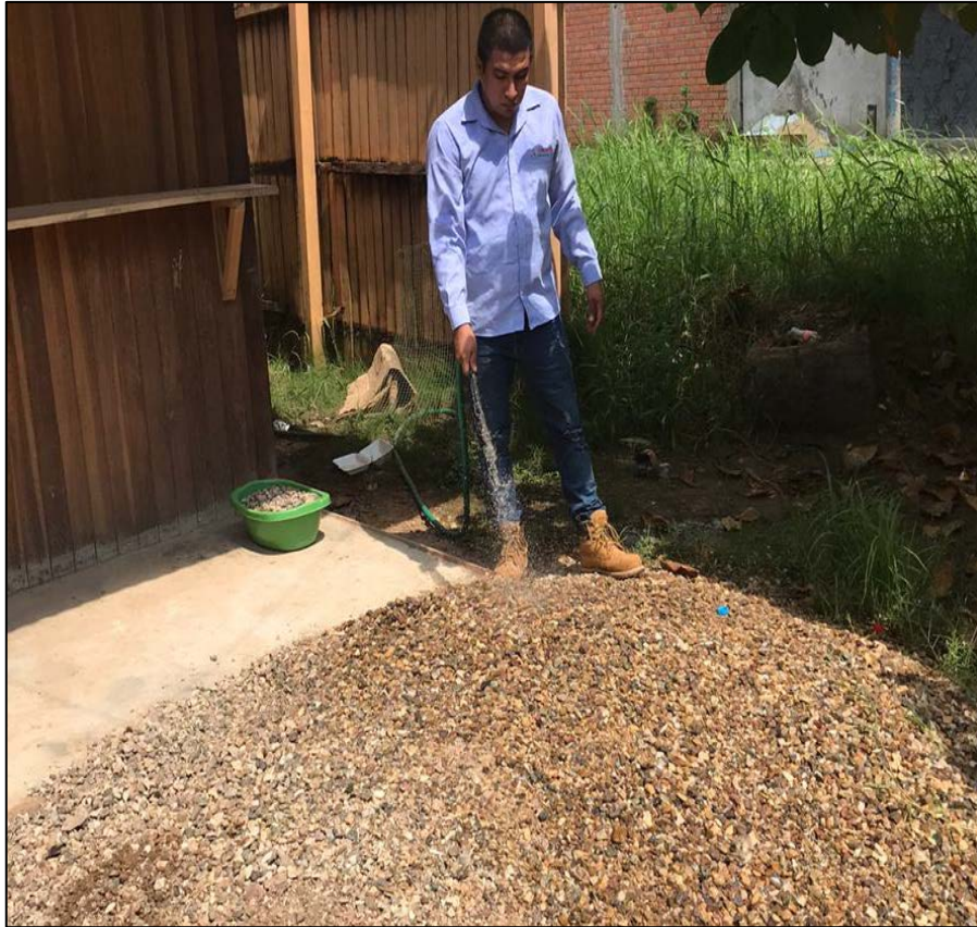
Imagen 7. Lavado del agregado grueso antes de realizar las probetas.
