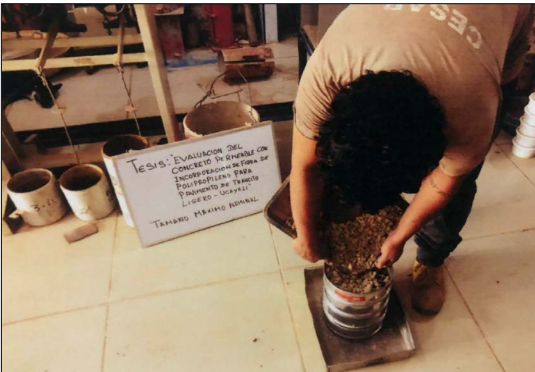
Imagen 6. Ensayo para determinar el tamaño máximo nominal del agregado grueso.
