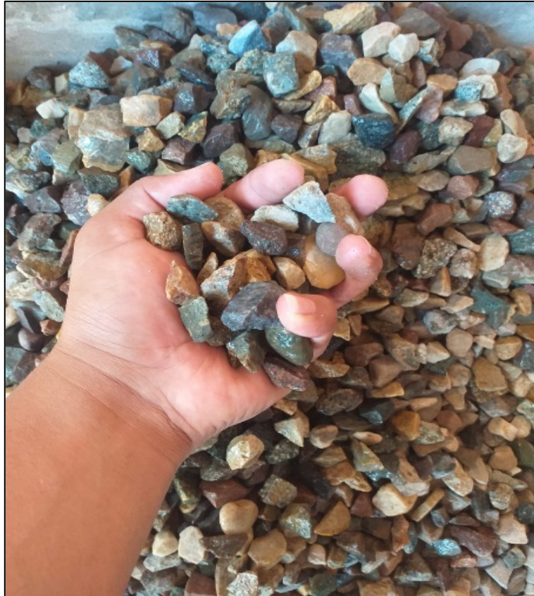
Imagen 9. Agregado Grueso después del lavado y zarandeado.
