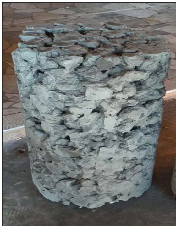
Imagen 12. Probeta de concreto permeable con incorporación de fibras de polipropileno.
