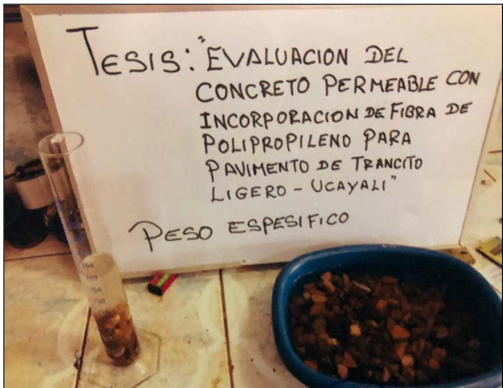
Imagen 4. Ensayo de Peso Específico del agregado grueso.
