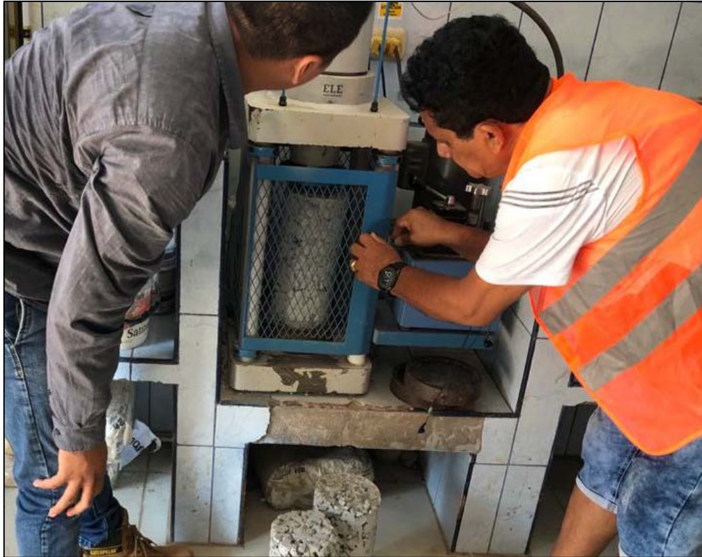
Imagen 13. Ensayo a compresión del concreto permeable con incorporación de fibras de polipropileno.
