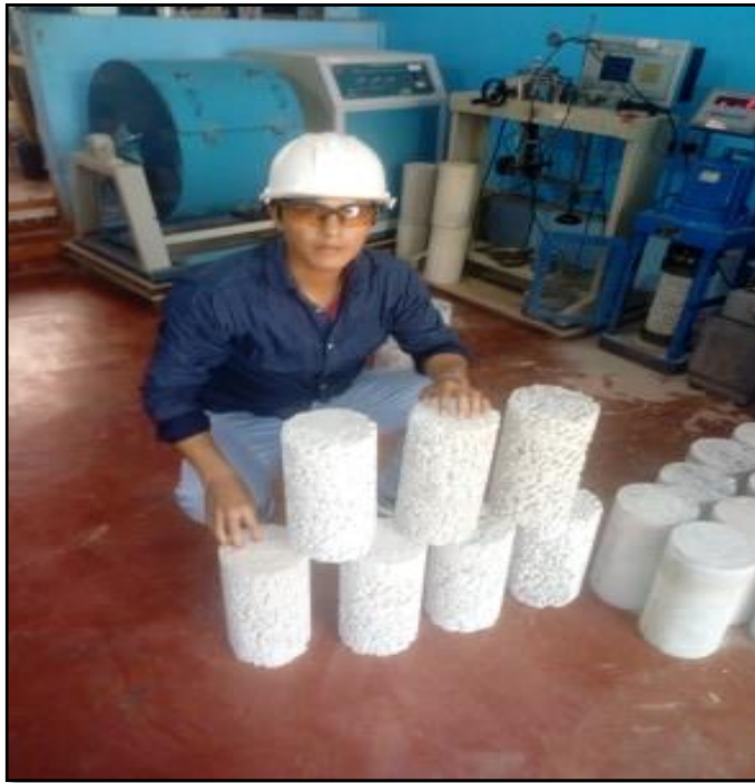
Foto N°01 Testigos sometidos a ensayo de compresión
