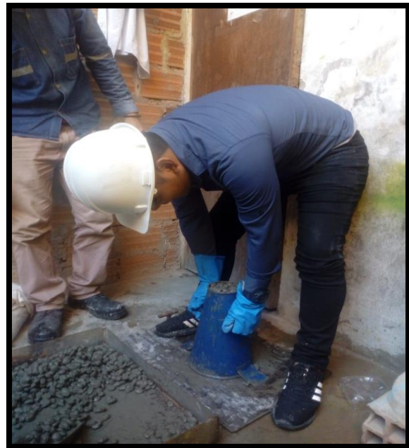
Figura 79 Prueba de Slump.
