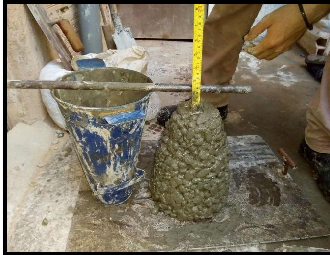
Figura 80 Slump resultante 2" (óptimo).
