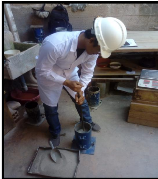
Figura 58 Llenado y compactado con 25 golpes cada capa, del agregado fino.
