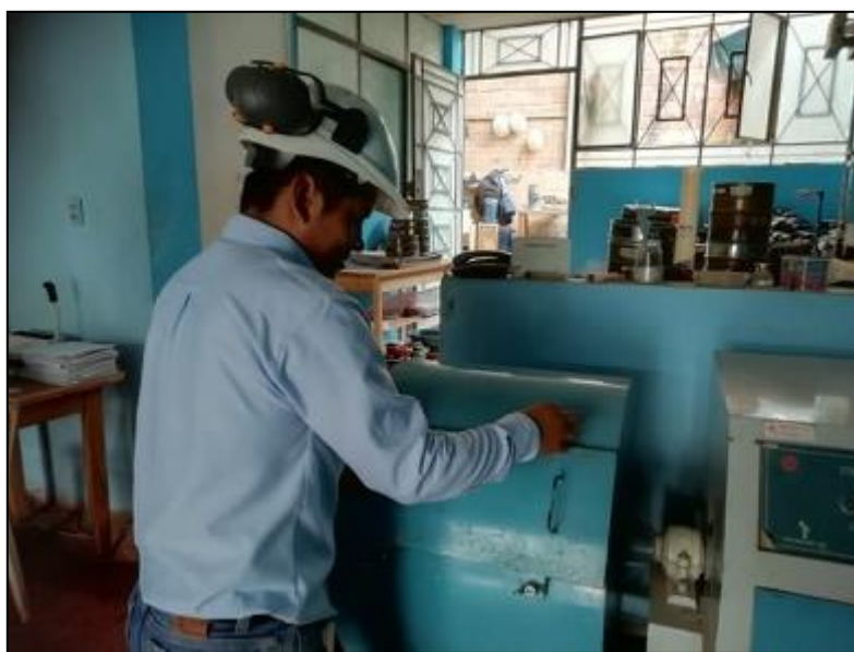
Foto N° 05 Apertura de la máquina de los ángeles, para el ensayo de abrasión del agregado grueso.
