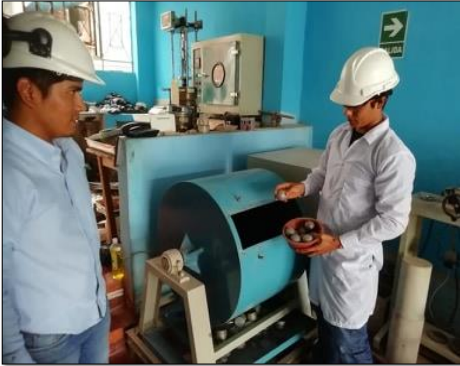
Foto N° 07 Colocación de las esferas de acero para iniciar las revoluciones en la maquina los ángeles
