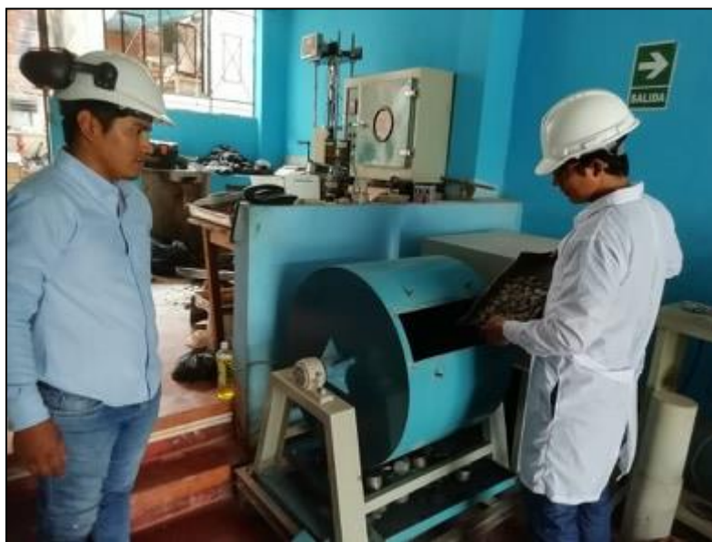
Foto N° 06 Colocación del agregado grueso en la máquina los ángeles
