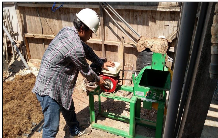
Figura 8. Proceso de Trituración del Escobajo de Palma Aceitera
