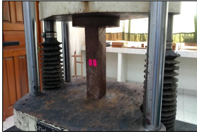
Figura 40. Ensayo de Compresión Paralela
