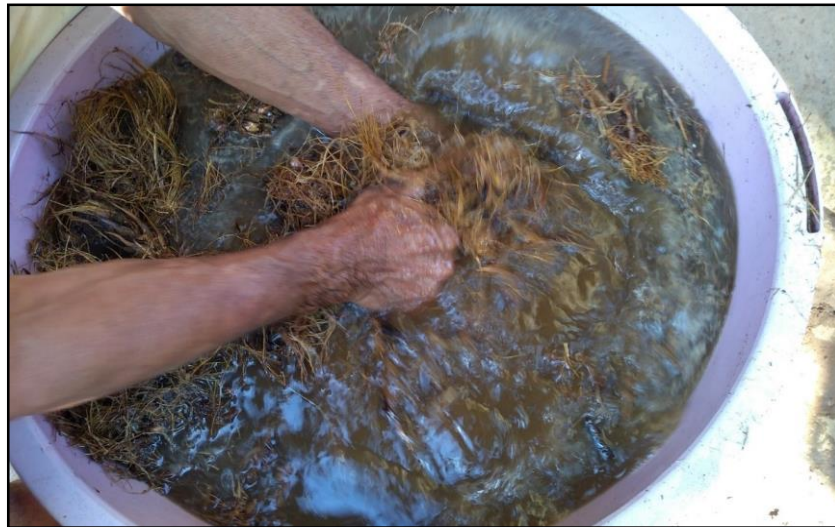
Figura 10. Lavado Manual del Escobajo de Palma Aceitera Triturado
