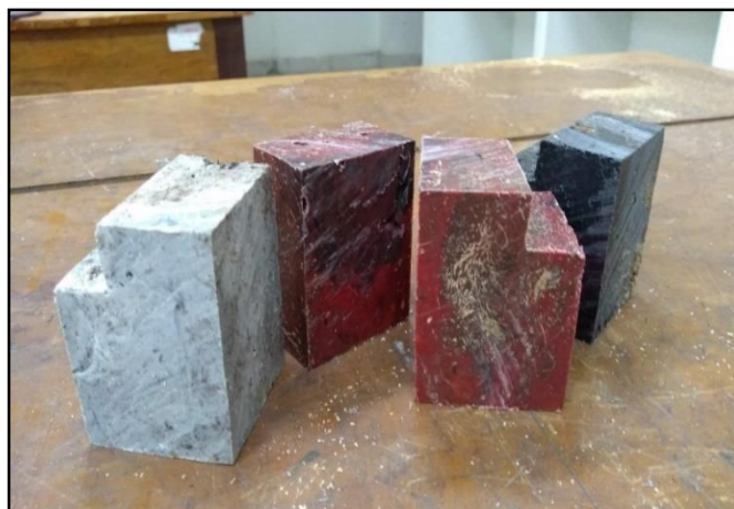
Figura 36. Probeta para Ensayo de Cizallamiento o Corte
