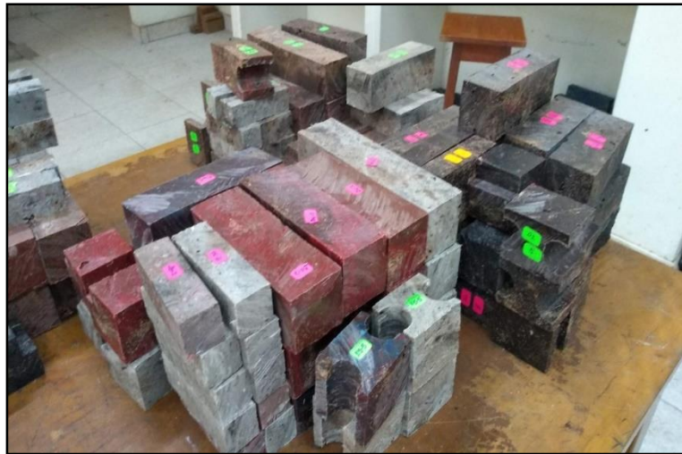
Figura 78. Muestras de Madera Plástica Listas para Ser Ensayadas
