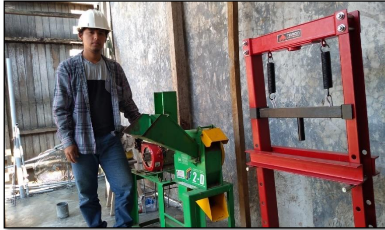
Figura 70. Instalación de la Trituradora de Escobajo y la Prensa Hidráulica
