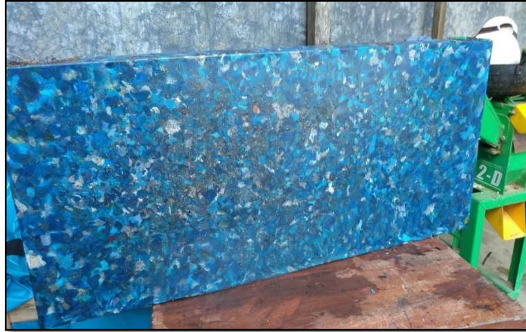
Figura 72. Muestra de la Madera Plástica Antes de Realizar los Cortes
