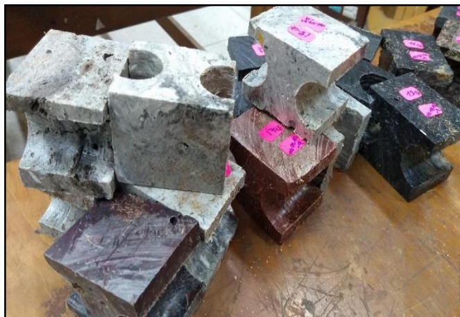
Figura 51. Probeta para Ensayo de Tensión Perpendicular
