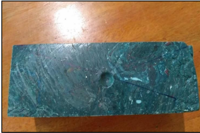
Figura 33. Probeta para Ensayo de la Dureza.
