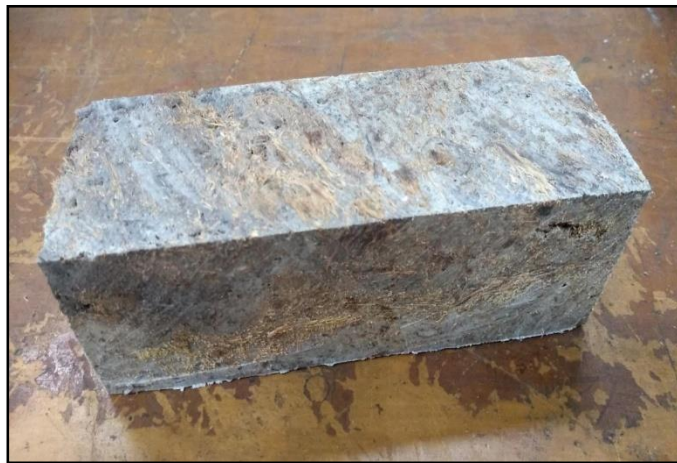
Figura 42. Probeta para Ensayo de Compresión Perpendicular
