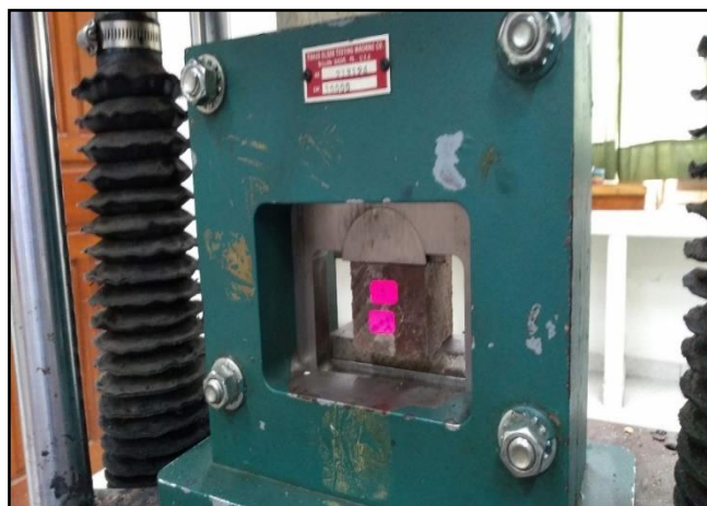
Figura 37. Ensayo de Cizallamiento o Corte
