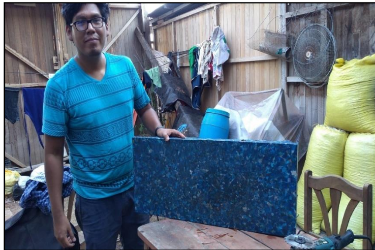
Figura 23. Madera Plástica Completamente Enfriada
