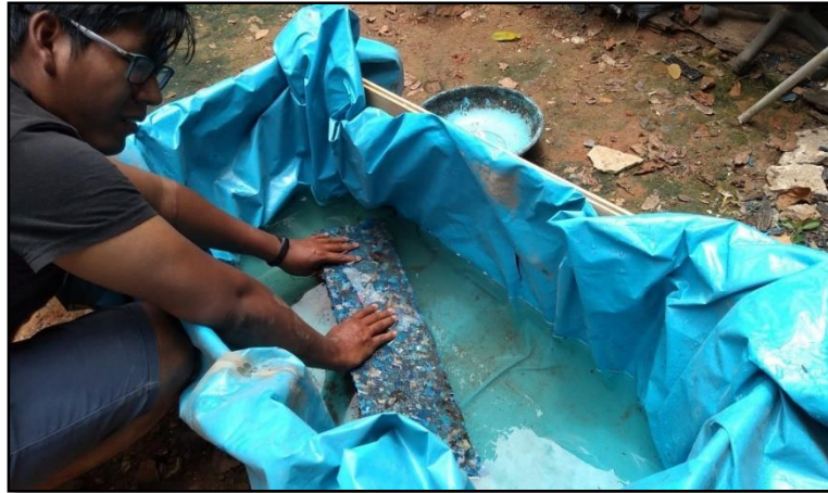
Figura 22. Enfriamiento de la Madera Plástica en Agua
