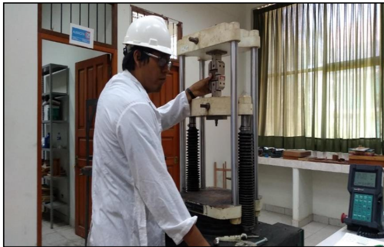
Figura 83. Colocación de la Muestra para el Ensayo de Tensión Perpendicular
