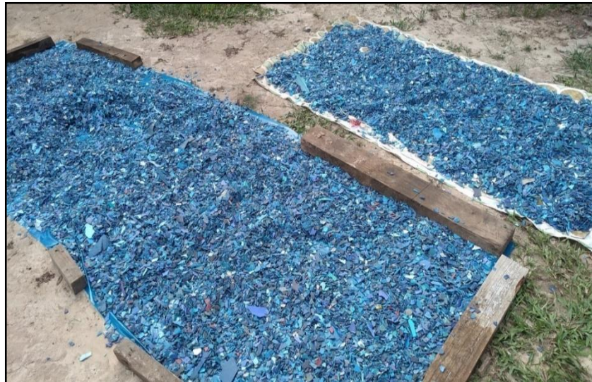
Figura 12. Secado del Plástico Triturado al Aire Libre
