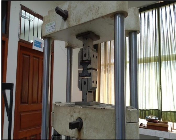
Figura 52. Ensayo de Tensión Perpendicular
