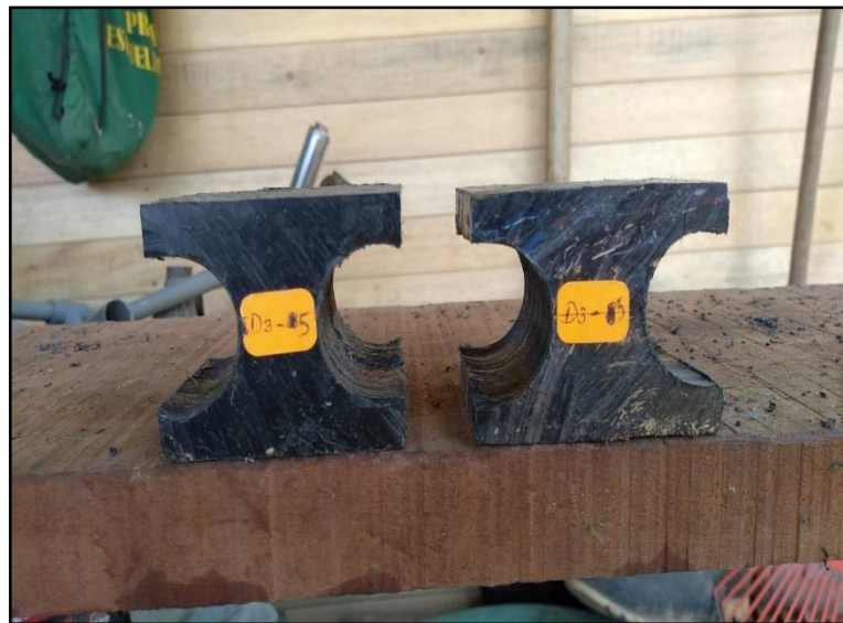
Figura 77. Corte de la Madera Plástica para Ensayo de Tensión Perpendicular
