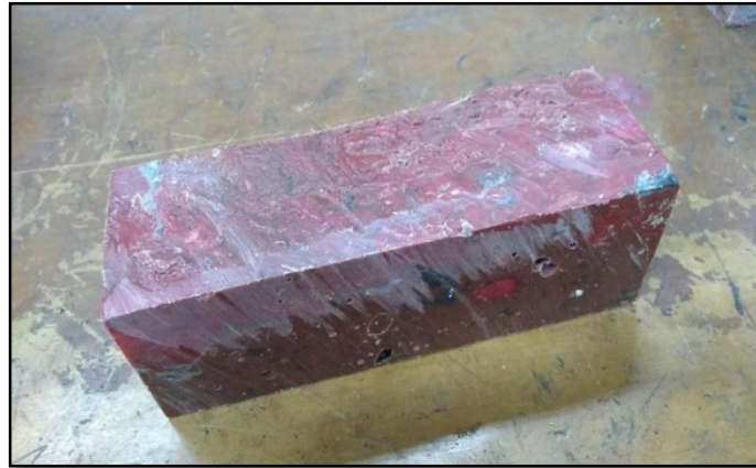
Figura 39. Probeta para Ensayo de Compresión Paralela
