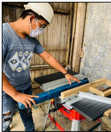
Figura 25. Corte de la Madera Plástica
