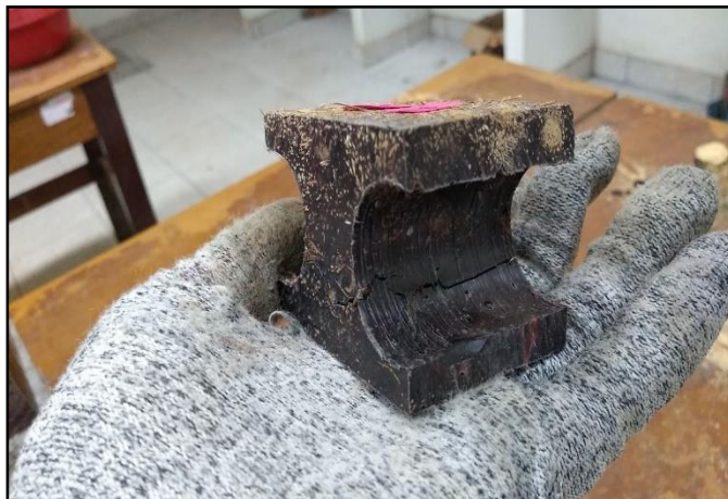
Figura 53. Línea de Falla en el Ensayo de Tensión Perpendicular
