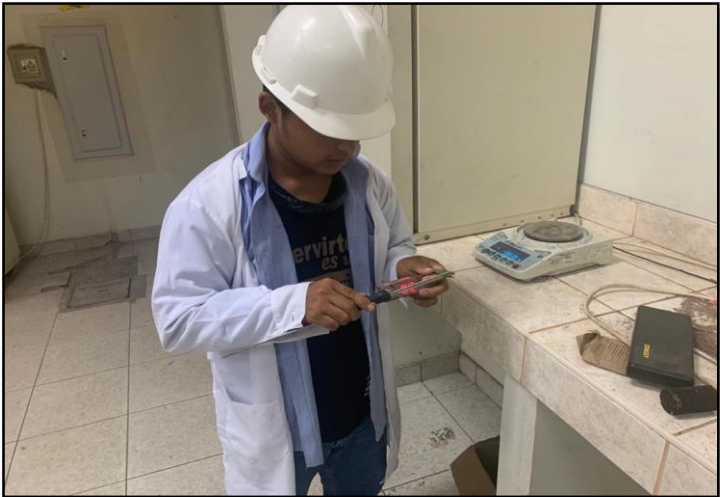
Figura 30. Medición de la Probeta para Cálculo del Volumen para Ensayo de la Densidad
