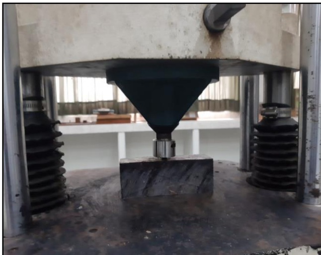
Figura 34. Ensayo para la Determinación de la Dureza
