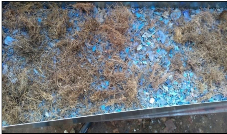
Figura 15. Mezclado del Plástico y Escobajo según Dosificación
