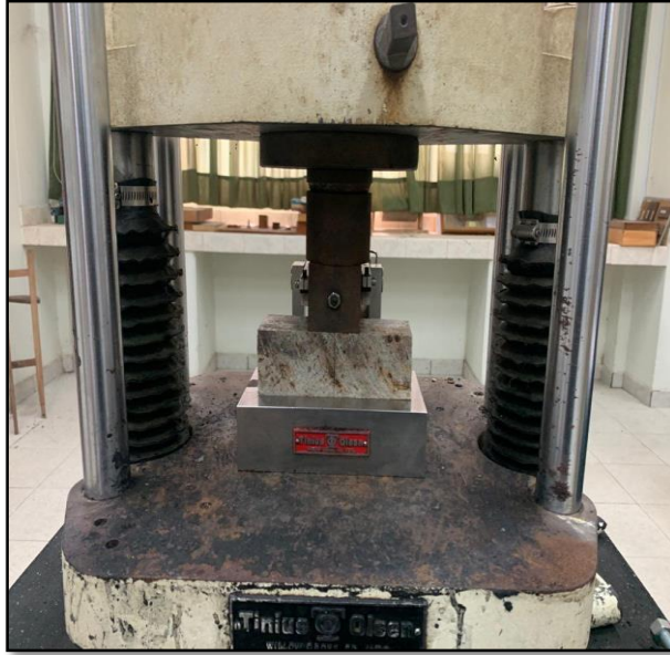
Figura 43. Ensayo de Compresión Perpendicular
