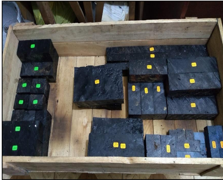
Figura 74. Avance de Probetas Cortadas Durante el Proceso de Fabricación
