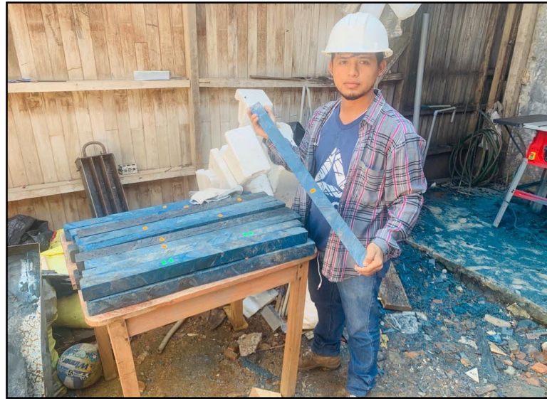
Figura 76. Madera Plástica Cortada para Ensayo de Flexión Estática
