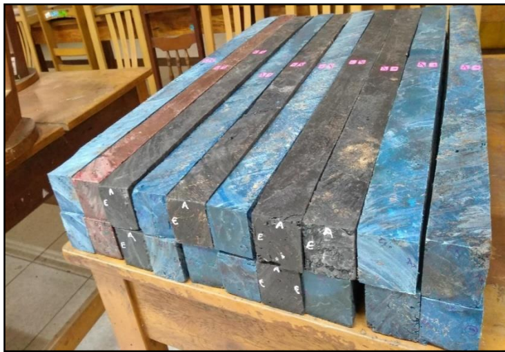
Figura 45. Probeta para Ensayo de Flexión Estática
