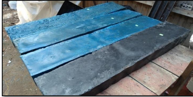
Figura 24. Bloques de Madera Plástica
