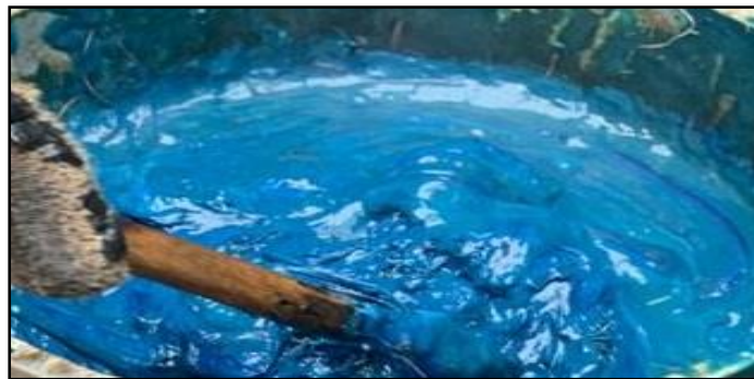
Figura 18. Plástico Fluido Antes de Combinarlo con el Escobajo
