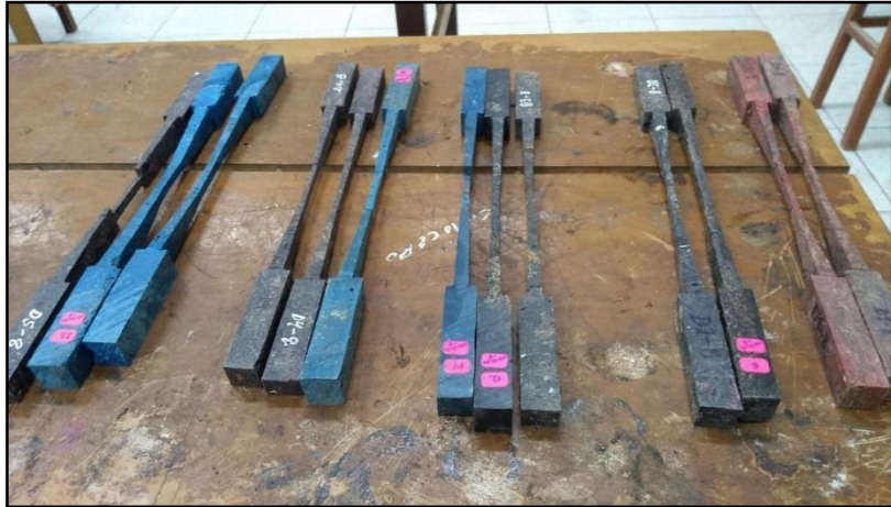
Figura 48. Probeta para Ensayo de Tensión Paralela
