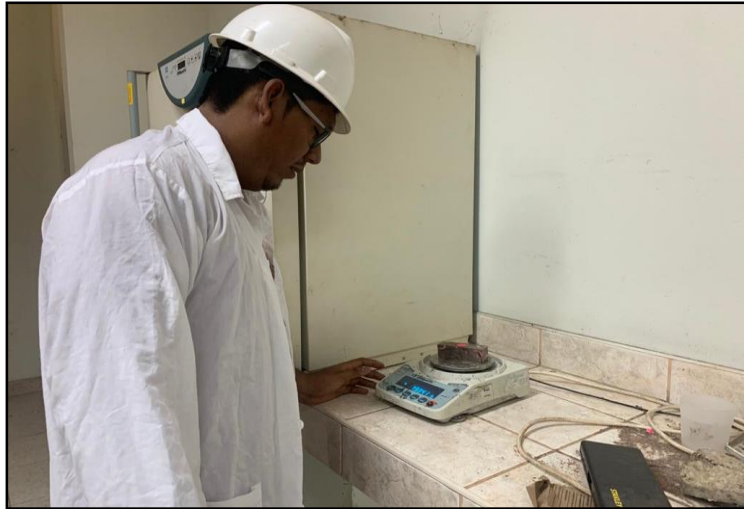
Figura 31. Medición de la Masa para Ensayo de la Densidad
