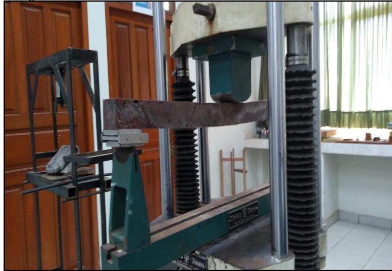
Figura 46. Ensayo de Flexión Estática
