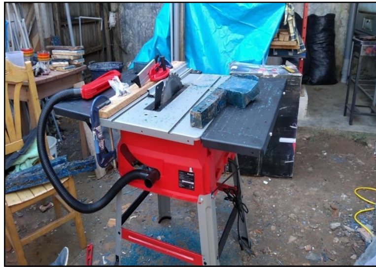
Figura 73. Cierra de Mesa Utilizada en el Corte de la Madera Plástica
