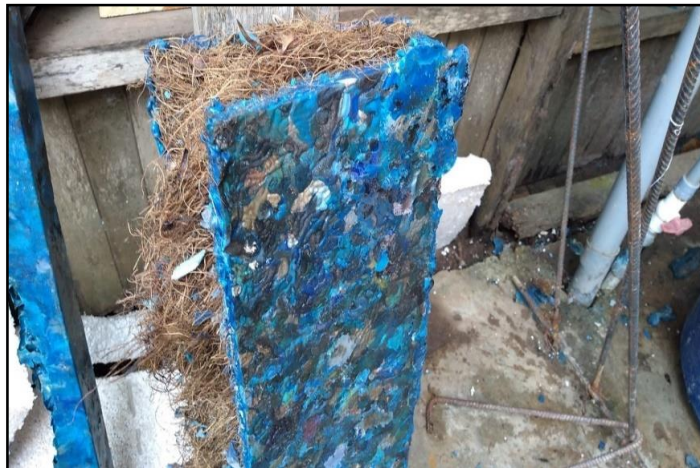
Figura 17. Resultado de la Primera Prueba de la Madera Plástica
