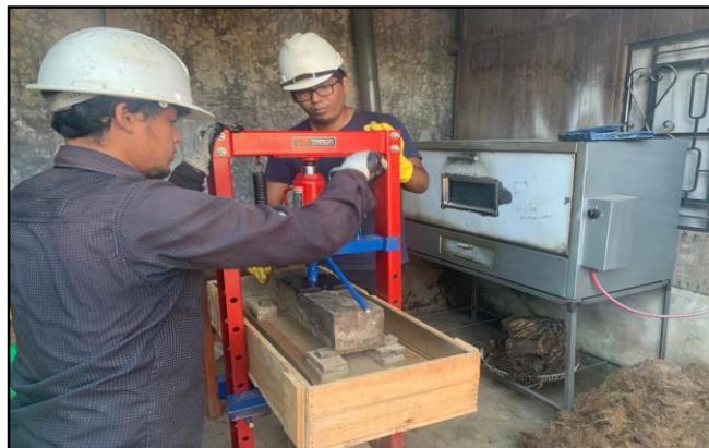
Figura 21. Prensado de la Madera plástica en Molde Grande
