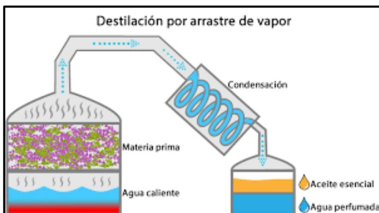
Figura 1. Método de destilación por arrastre de vapor
