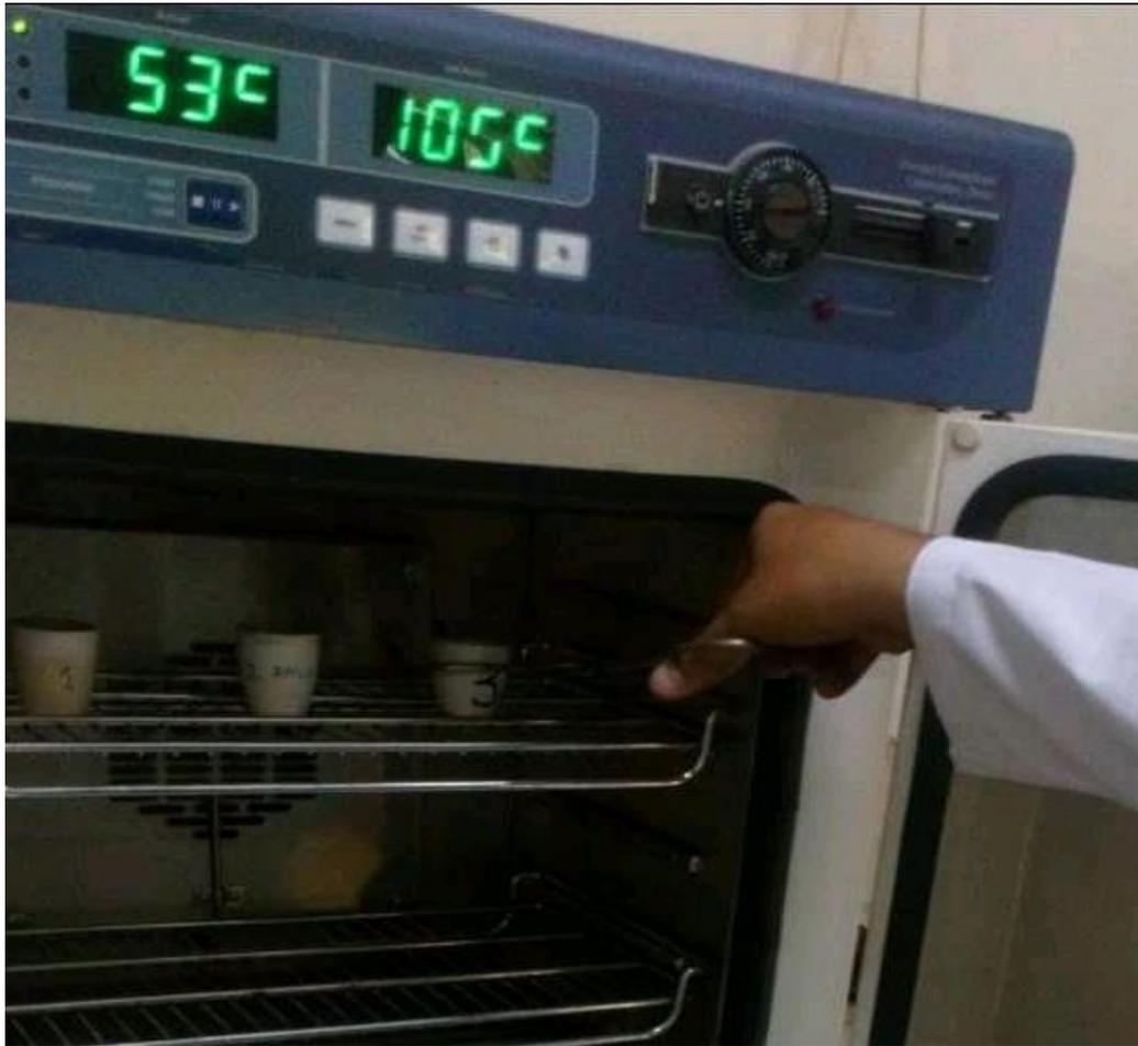
foto 4. Secando las muestras en el horno
