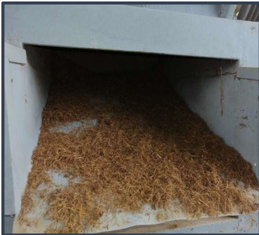
Figura 24. Proceso de trituración de las muestras de escobajo y fibra de palma aceitera, en los laboratorios de la UNU
