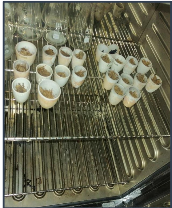
Figura 25. Determinación de humedad inicial utilizando la metodología ATMS D 644-99
