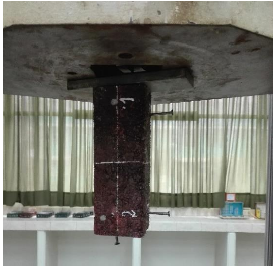
Figura 5. Ensayo de extracción de clavos
