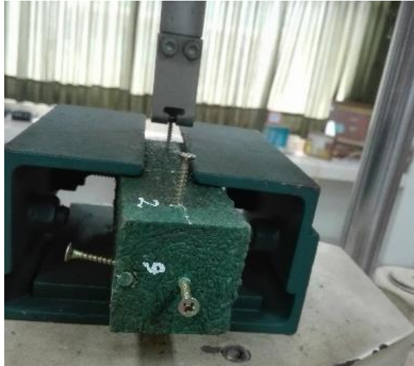
Figura 6. Ensayo de extracción de tornillo
