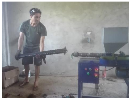
Extrusado y preparado del material compuestos
