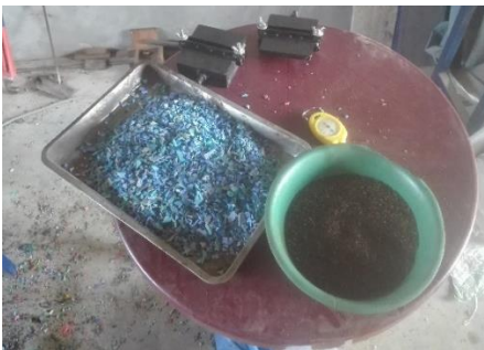
Pesado y mezclado del material (ppr con cuesco)
