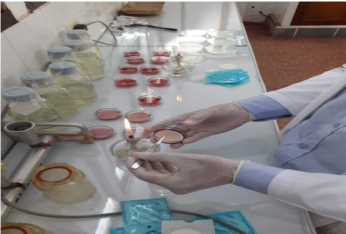
Figura 43. Método de filtración por membrana para la determinación de coliformes totales y termotolerantes.
