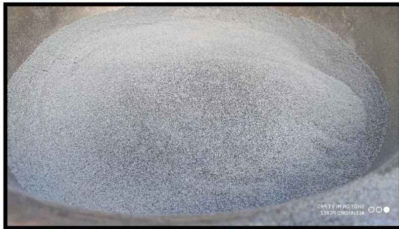
Figura 18: CENIZA DE CÁSCARA DE ARROZ, PRODUCTO DEL SEGUNDO PROCESO DE CALCINACION.
