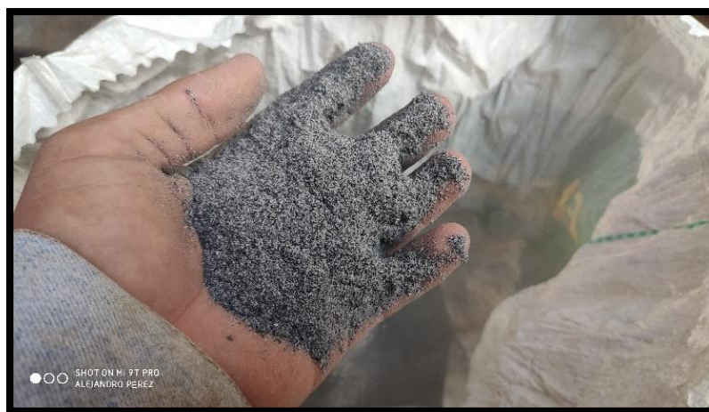
Figura 15: EXTRACCION DE LA CENIZA DE CÁSCARA DE ARROZ, PRODUCTO DEL PRIMER PROCESO DE CALCINACION.
