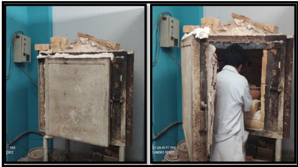
Figura 17: SEGUNDO PROCESO DE CALCINACION DE LA CÁSCARA DE ARROZ.
