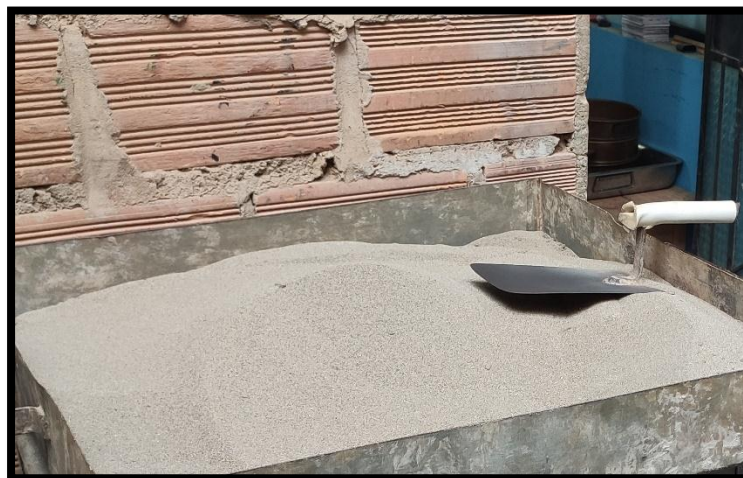
Figura 5: AGREGADO FINO – ELIMINACION DE AGUA
