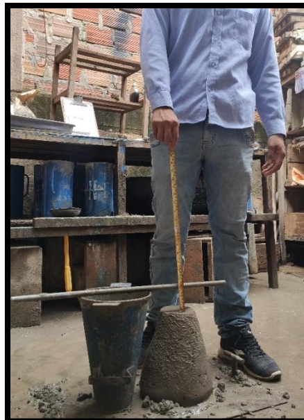
Figura 23: MEDICION DEL SLUMP DEL MORTERO PATRÓN.
