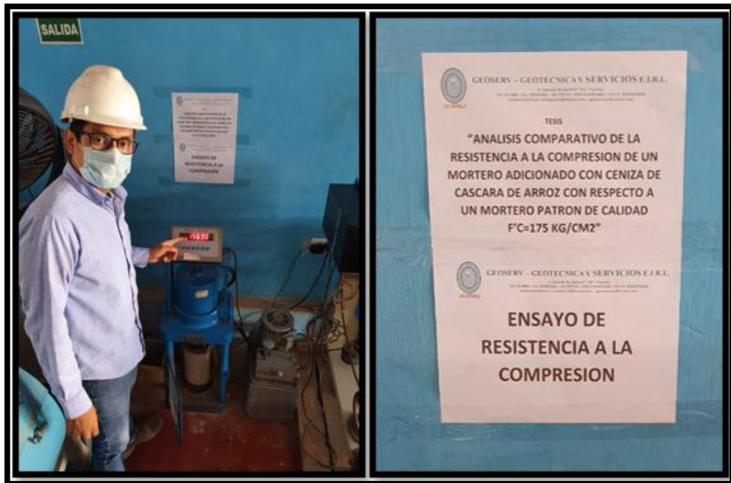
Figura 39: RESISTENCIA A LA COMPRESIÓN.
