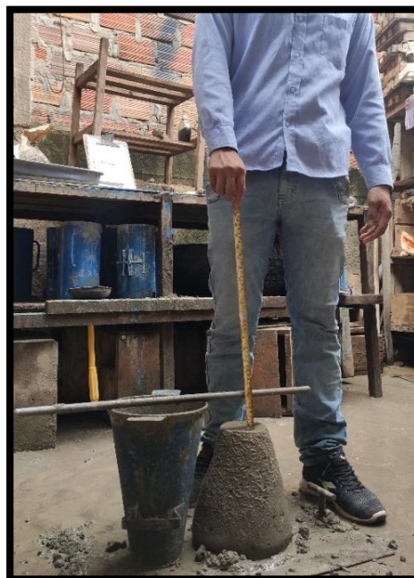
Figura 23: MEDICION DEL SLUMP DEL MORTERO PATRÓN.
