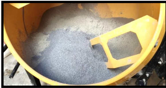
Figura 30: INCORPORACION DE LA CENIZA DE CÁSCARA DE ARROZ A LA MEZCLA.
