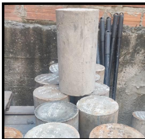
Figura 26: DESMOLDE Y CODIFICACION DE LOS TESTIGOS DE MORTERO PATRÓN.
