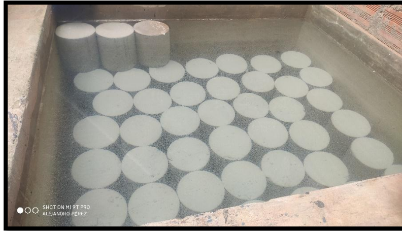
Figura 32: CURADO DE TESTIGOS DE MORTERO CON ADICION DE CENIZA DE CÁSCARA DE ARROZ.
