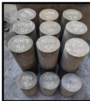
Figura 11: MUESTRAS CILÍNDRICAS DE MORTERO PARA ENSAYOS DE COMPRESIÓN ESTÁNDAR.
