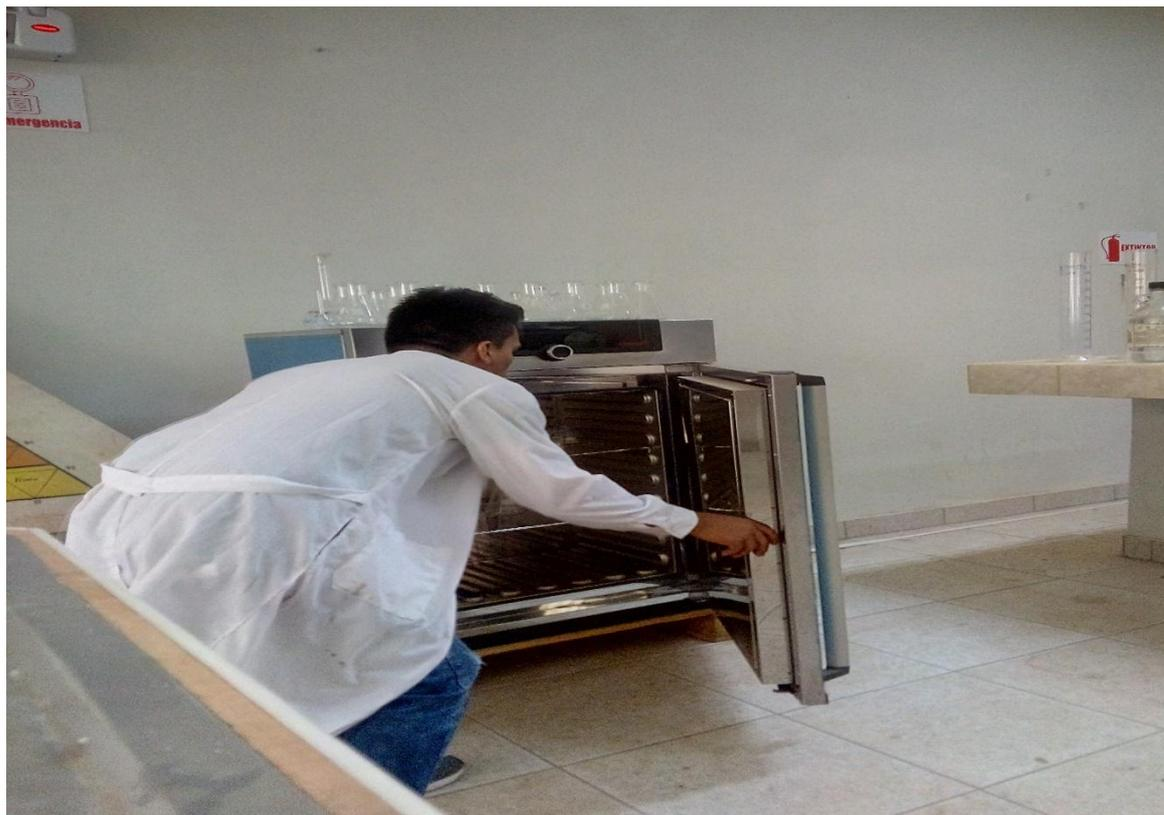
Figura 39A. Colocamos la muestra en la estufa.
