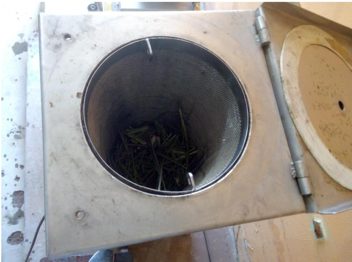
**Figura 23A. Colocación de la hierba luisa al destilador por arrastre de vapor.**
