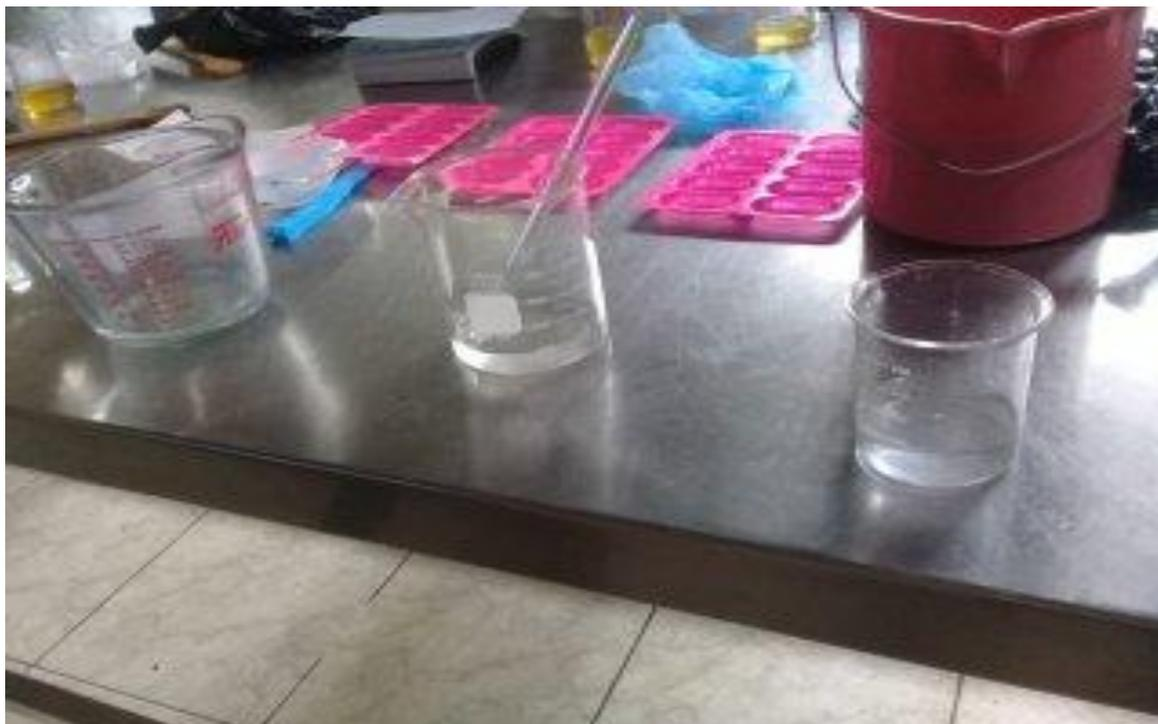
**Figura 25A. Elaboración del jabón de tocador, dilución de la sosa caustica (NaOH) en agua destilada.**
