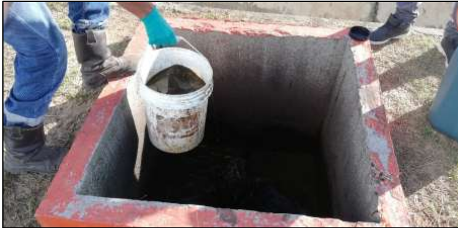
Figura 18. Toma de muestras de Biol en el Rebose del Biodigestor de la PTARI Olamsa
