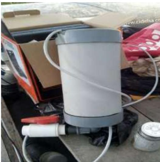
**Figura 27.** Equipo analizador de gases portátil terminado.
