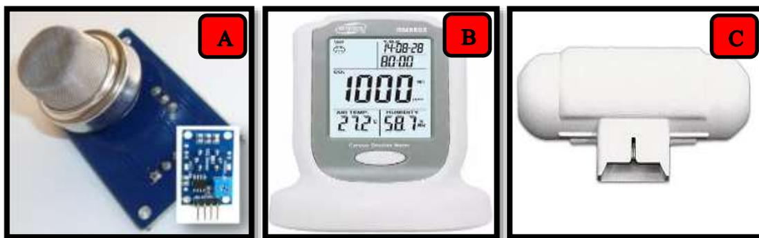
Fuente: A) sensor de gas, Seeed Studio, B) sensor de CO<sub>2</sub>, BENETECH, C) sensor de H<sub>2</sub>S, PCE Instruments.
