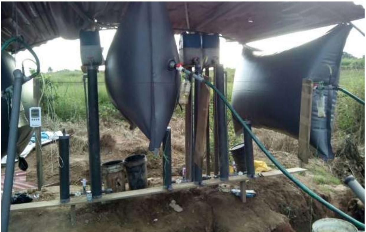
**Figura 43.** Gasómetros para cada biodigestor colocados de forma suspendida y con sus respectivas conexiones.
