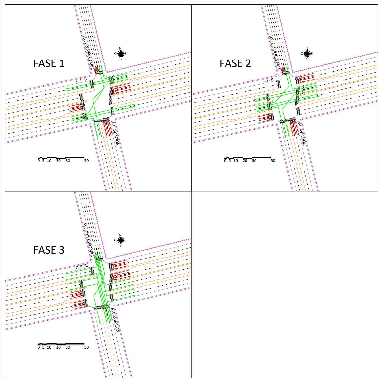
SEMAFORIZACIÓN DE LA INTERSECCIÓN 04 ESCALA: 1/2,000
