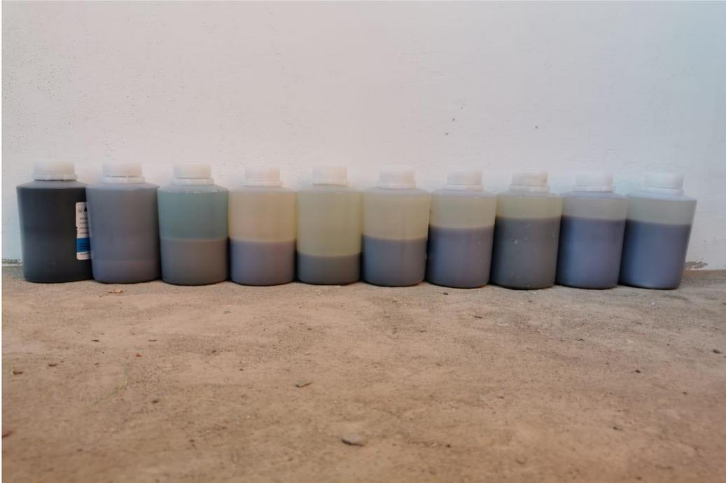
**Figura 21.** Muestras final del proceso de electrocoagulación.
