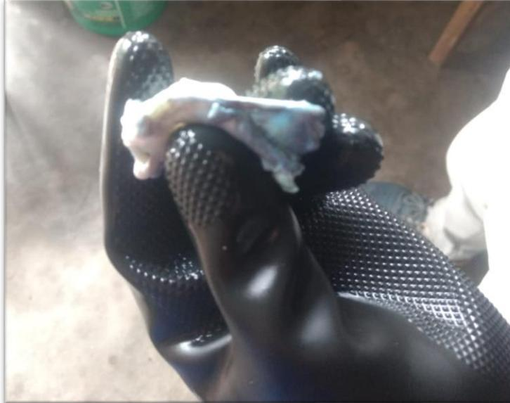
**Figura 11.** Verificación del contenido ácido con el indicador bromo cresol.
