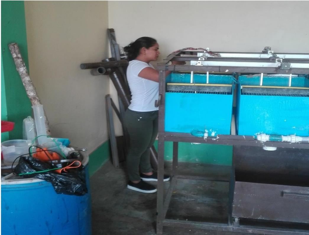
**Figura 23.** Acondicionamiento del sistema de electrocoagulación.
