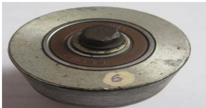
Figura 25. Ruedas de aluminio con rodajes encajados
