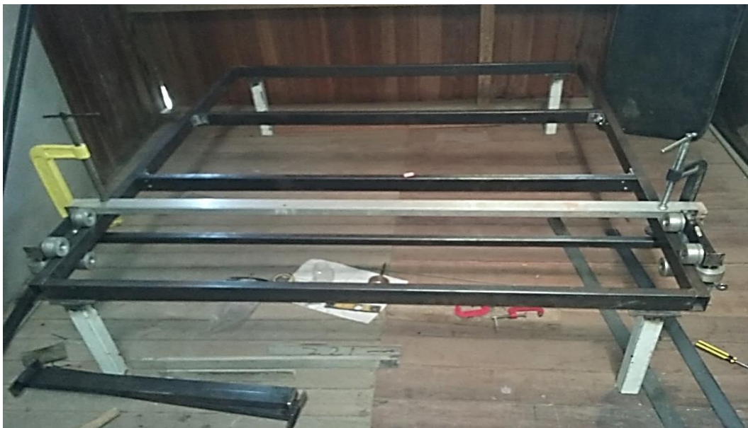
Figura 18. Ensamblaje de las ruedas con la plataforma principal.
