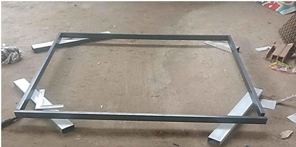
Figura 16. Plataforma principal y base del eje Y.
