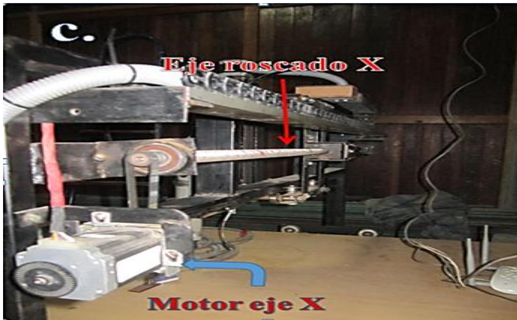
Figura 21. C. Adaptación del motor en el eje X.
