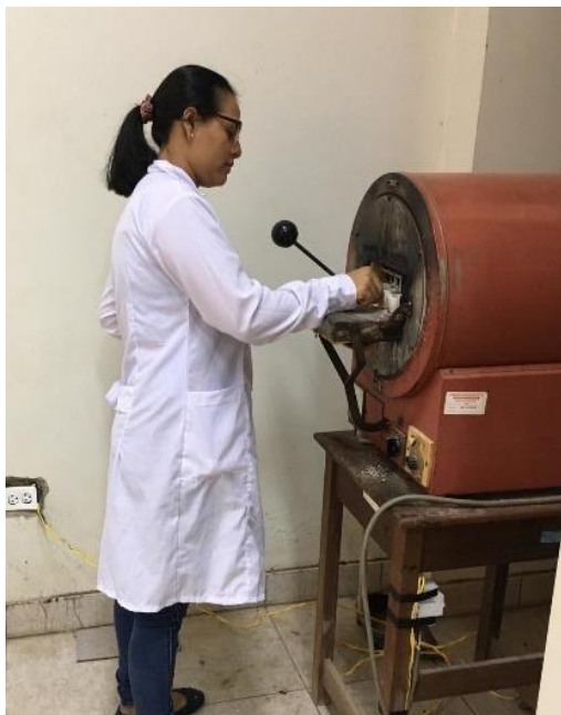
Figura 17A. Ingresamos al horno nuestra muestra para realizar método de análisis obtención de ceniza.
