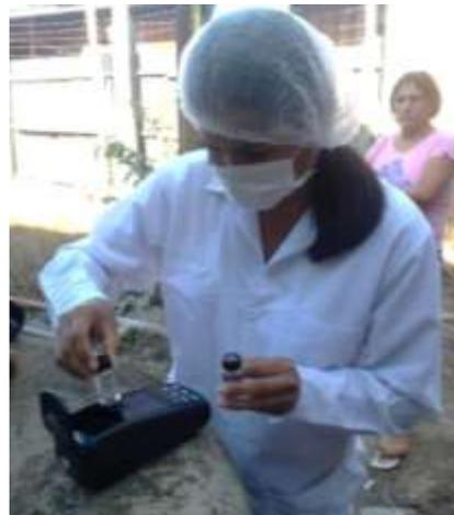
**Figura 42.** Análisis de cloro residual en campo
