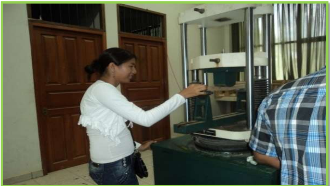
Figura 16. Realizando los ensayos de propiedades mecánicas en el laboratorio de Tecnología de la Madera de la Universidad Nacional de Ucayali
