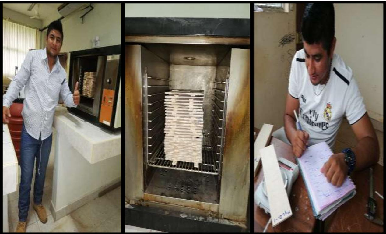
**Figura 18.** A la derecha ingreso de las probetas a la estufa. En el centro apilado de las probetas en la estufa. A la derecha pesado final de las probetas, para determinar el contenido de humedad.
