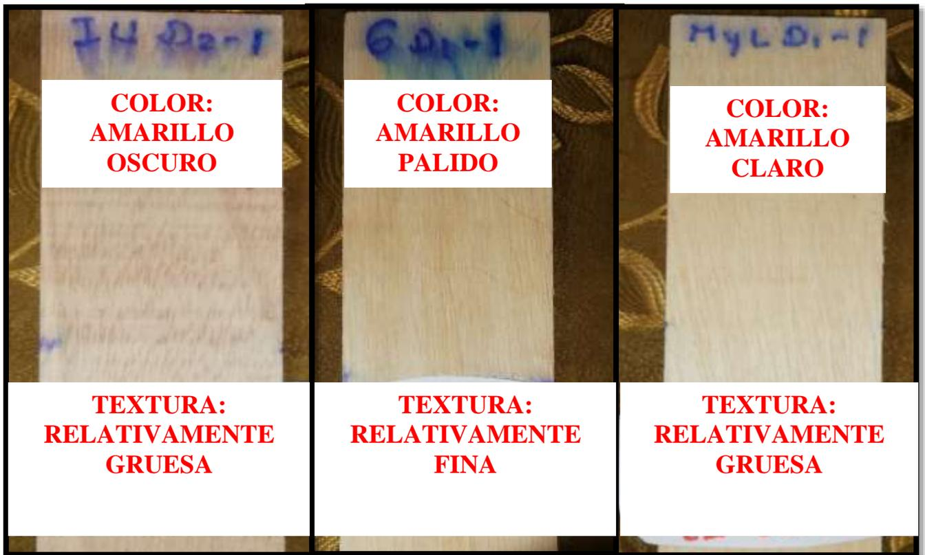
**Figura 23.** Clasificación de textura y color a nivel macroscópico de las probetas de tableros contrachapados de *Ceiba pentandra* L. Gaertn (lupuna blanca).
