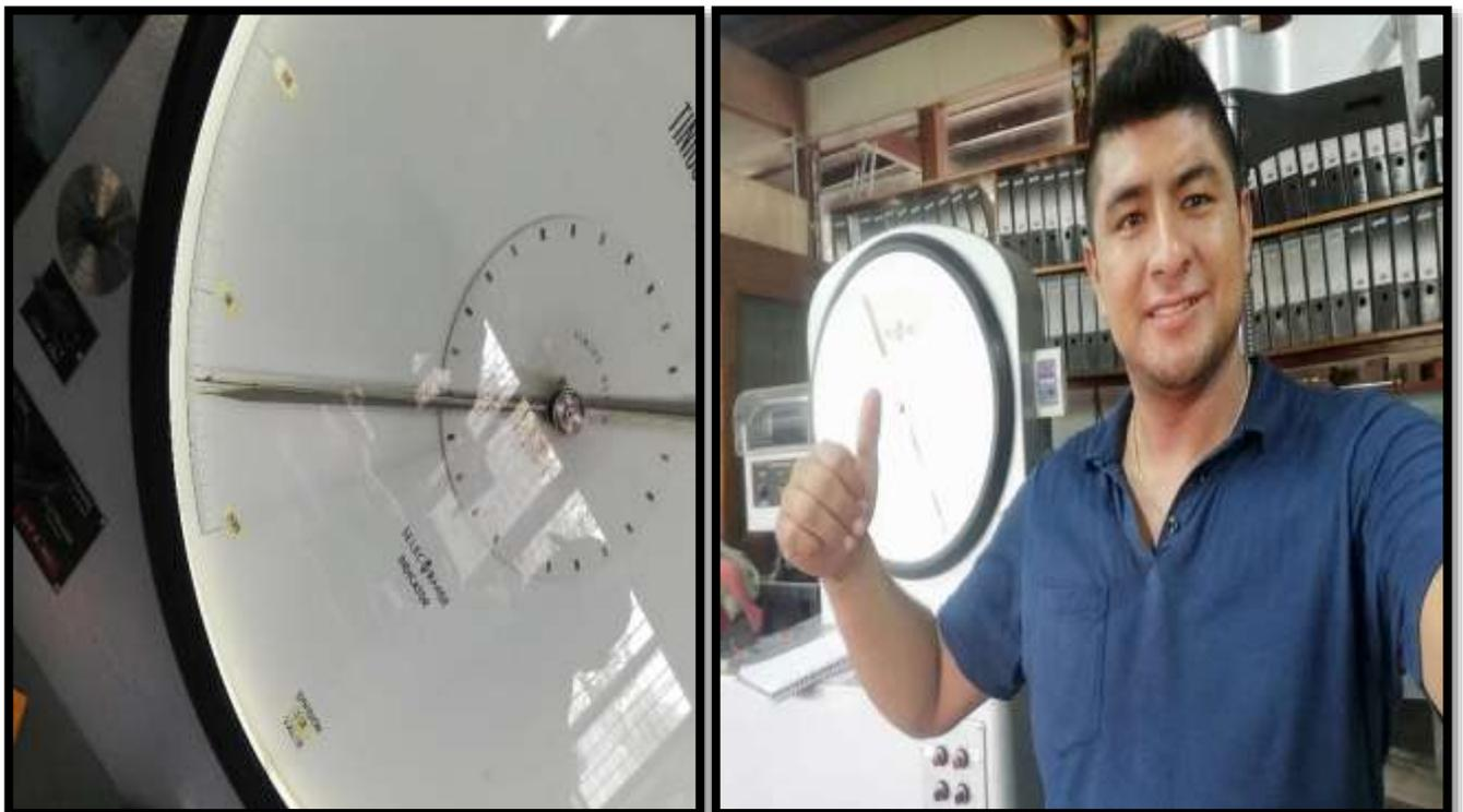
**Figura 24.** Momento de la lectura e interpretación de las cargas en la prensa universal de las propiedades mecánicas de tableros contrachapados.
