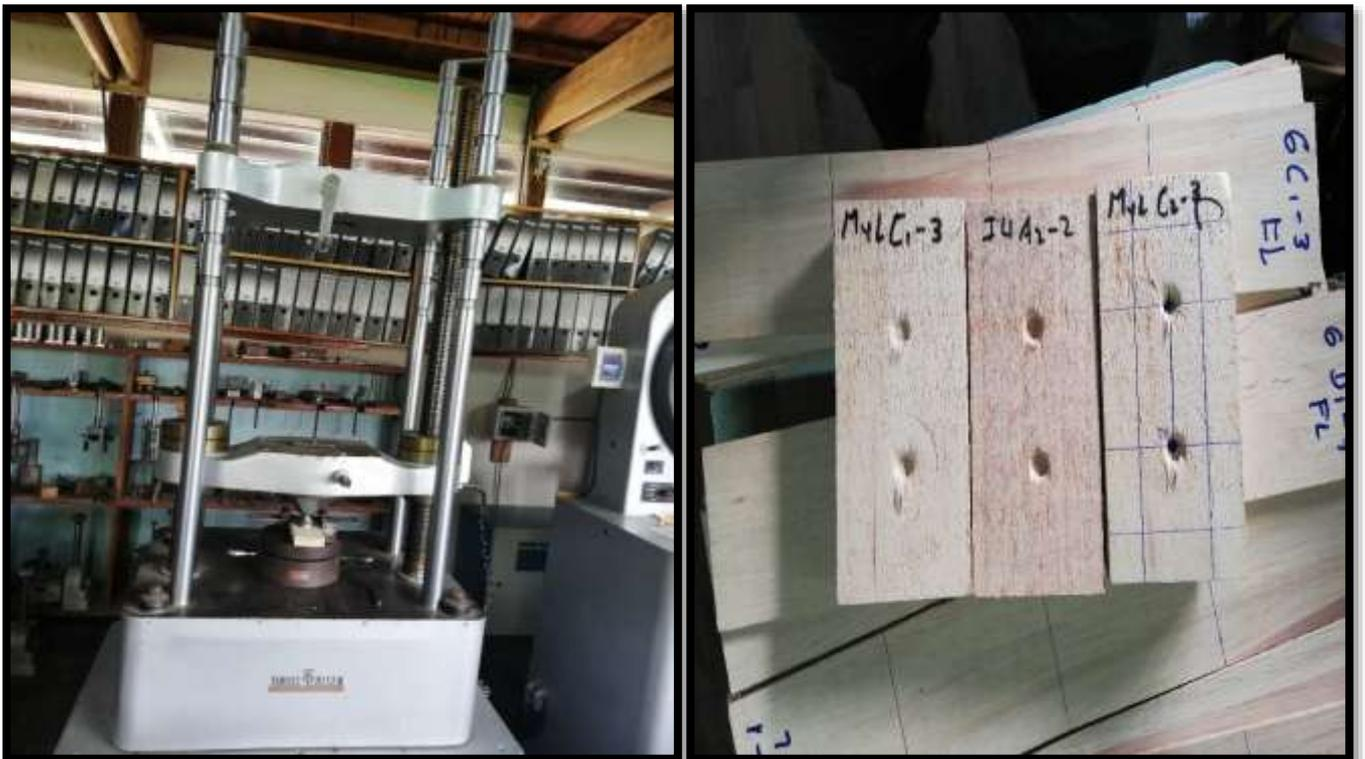
**Figura 22.** A la izquierda el momento donde se aplica la carga para la determinación de la dureza. A la derecha las probetas después de haber recibido la carga
