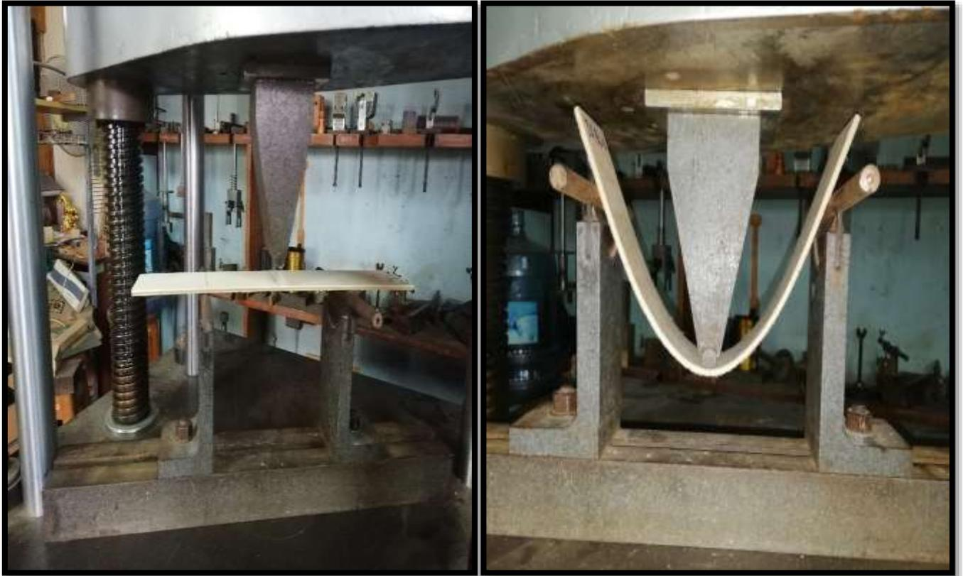
**Figura 21.** A la izquierda la probeta antes de aplicar la carga. A la derecha la probeta después de aplicar la carga máxima hasta una posible falla para determinar el módulo de ruptura transversal.
