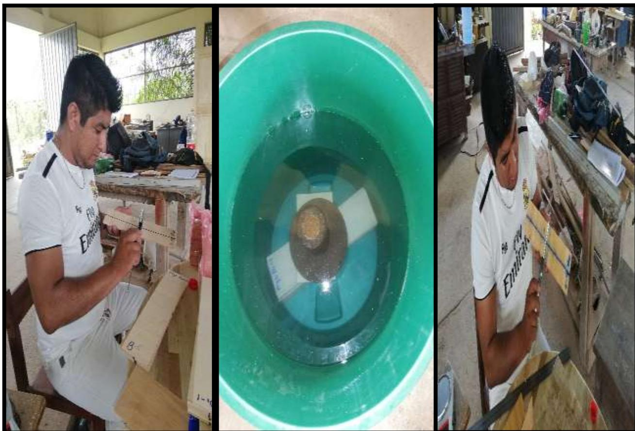
**Figura 19.** A la izquierda medición inicial de las probetas antes de inmersión en agua. En el centro las probetas en agua durante 1h. A la derecha medición final de las probetas después de la inmersión en agua, para determinar la expansión.
