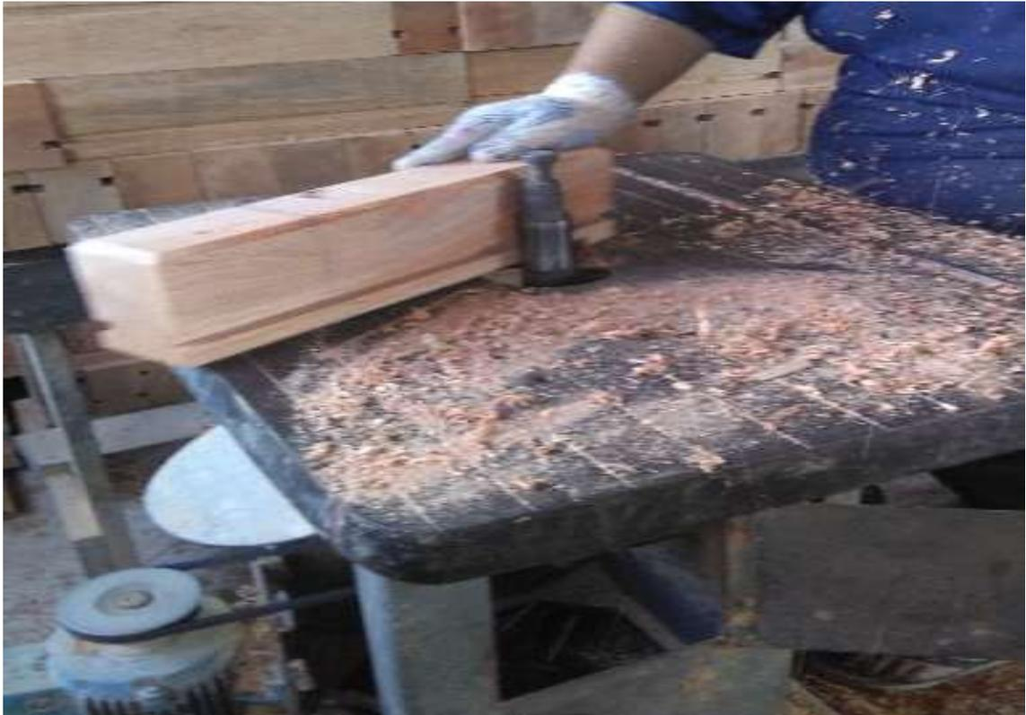
**Figura 11A.** Proceso de bicelado.
