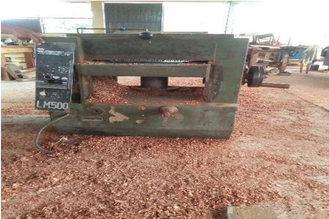
**Figura 9A.** Máquina para el proceso de cepillado.
