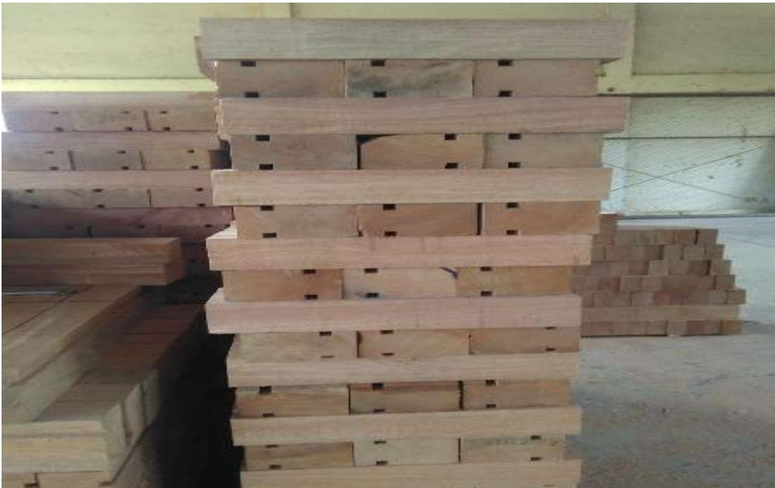
**Figura 8A.** Acabado del proceso de ranurado.
