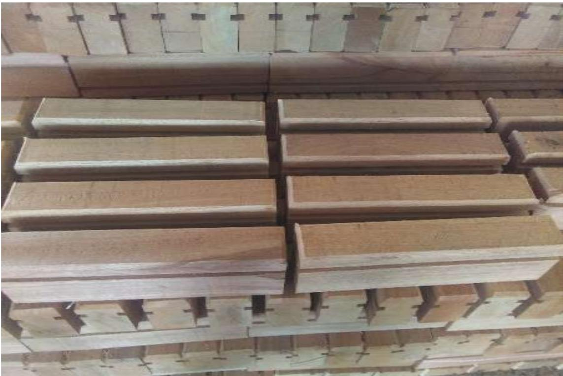
**Figura 10A.** Acabado del proceso de cepillado.
