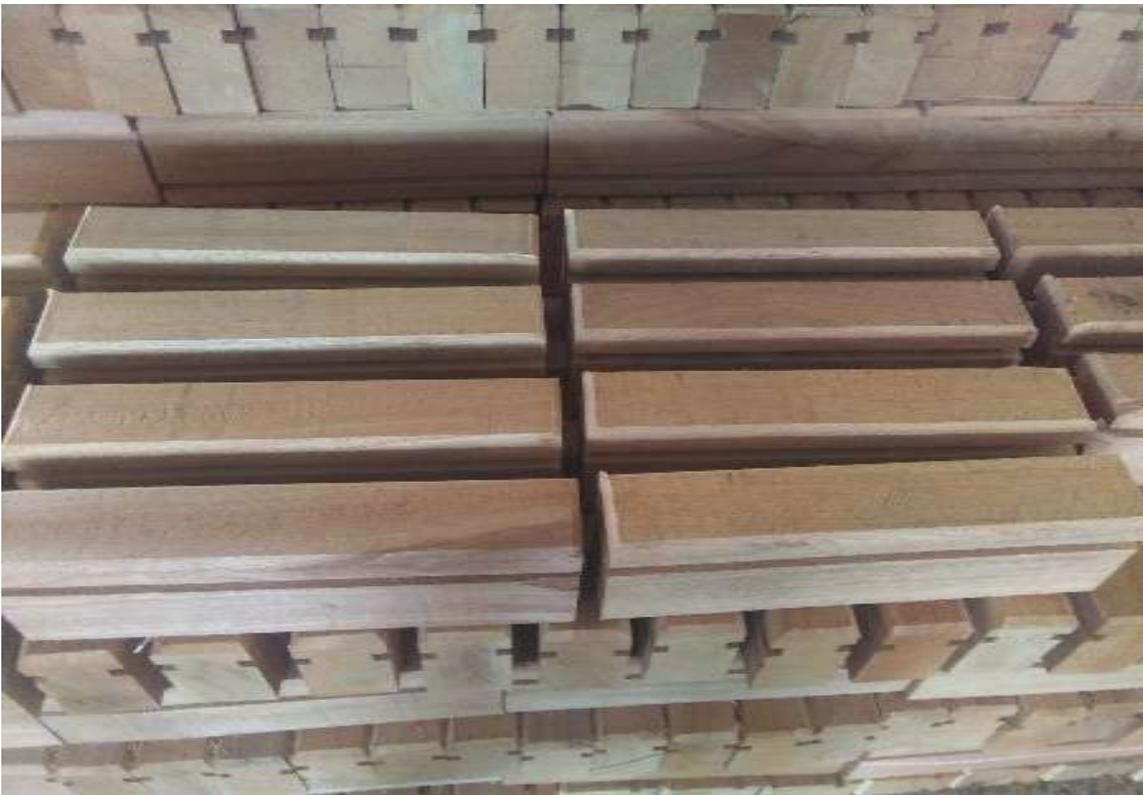
**Figura 12A.** Acabado del proceso de bicelado.
