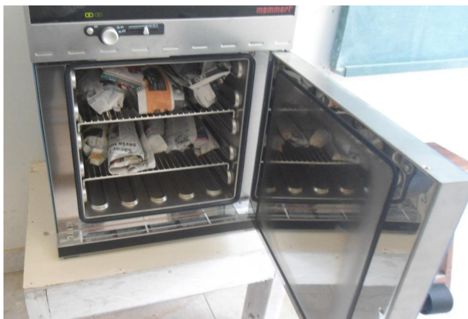
Ilustración 295: Estufa del laboratorio de fisiología vegetal para determinar el peso seco de lechuga
