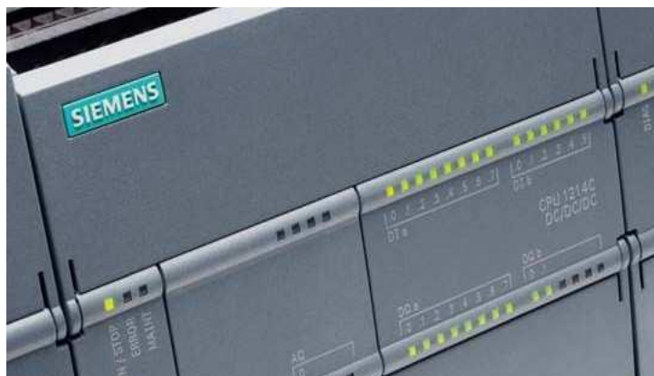
Ilustración 20: Led indicadores del PLC Siemens 1200.
