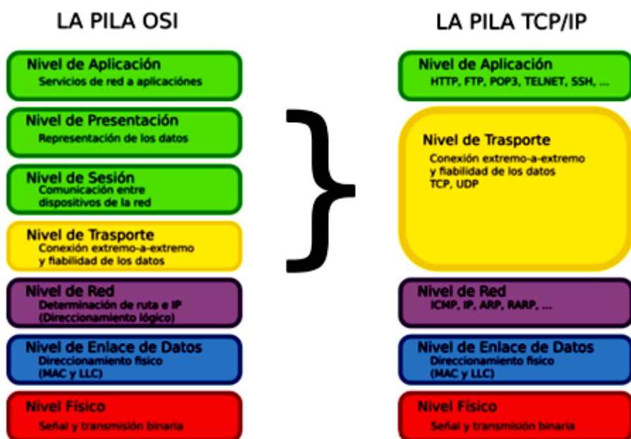
Ilustración 16: Modelo OSI y modelo TCP/IP
