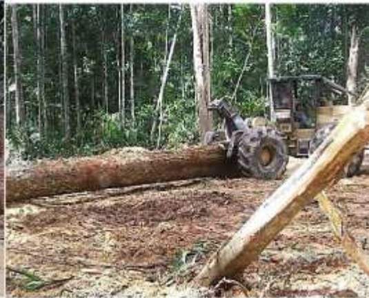
Fig. 15. Compactación por arrastre de trozas
