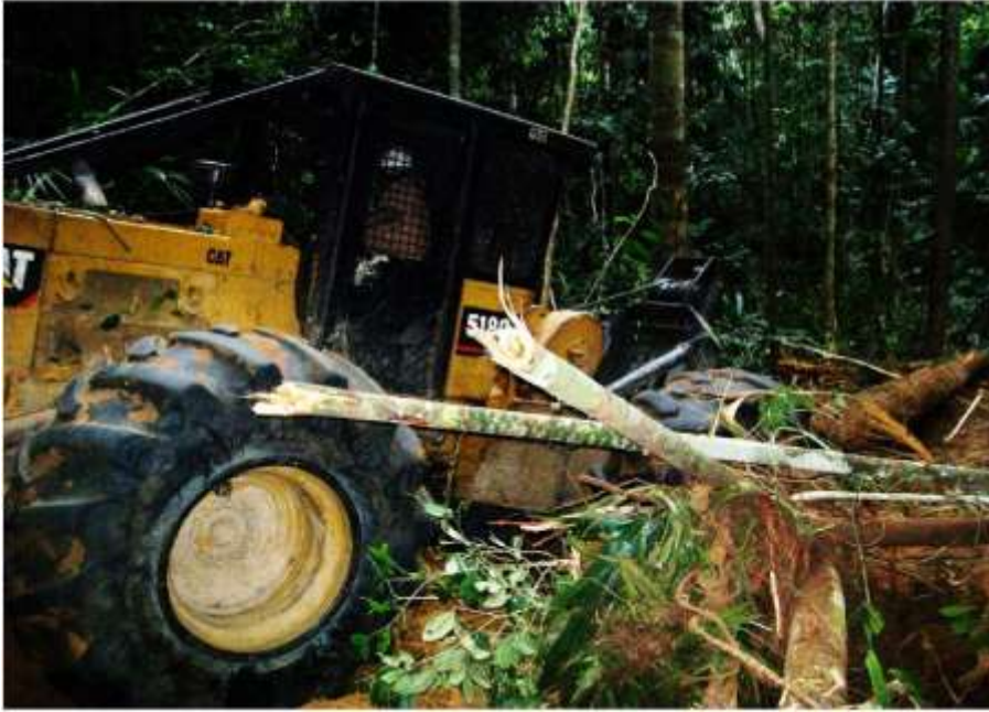
Daños a la vegetación por arrastre de trozas
