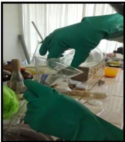
Figura 9A. Se agrega el metoxido al aceite para la reacción de transesterificación.
