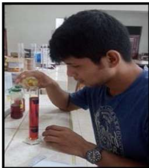
Figura 21A. Muestras para la determinación de viscosidad por caída de bola.
