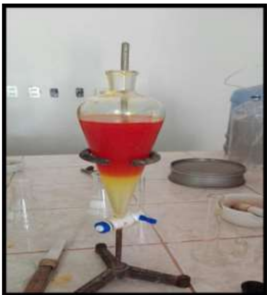
Figura 13A. Separación del agua y el biodiesel.
