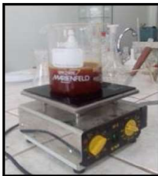
Figura 4A. Acondicionamiento del aceite a 60°.
