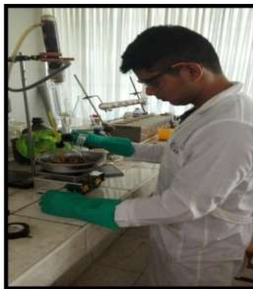
Figura 10A. Proceso de transesterificación por 90 minutos, a 60°C.
