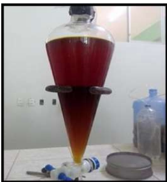
Figura 11A. Etapa de separación de fases entre el biodiesel y la glicerina.
