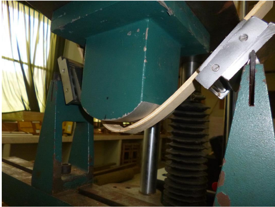
Foto 12: Ensayo de Tracción perpendicular
