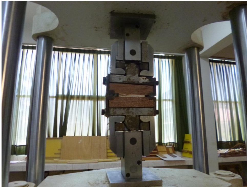
Foto 12: Ensayo de Tracción perpendicular
