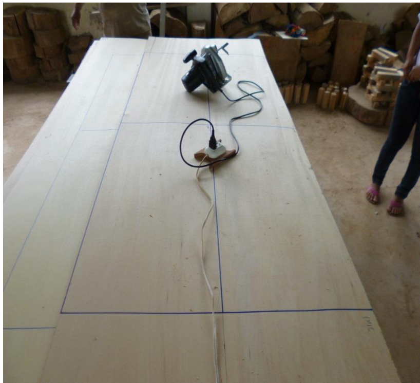
Foto 2: Corte de las láminas de triplay
