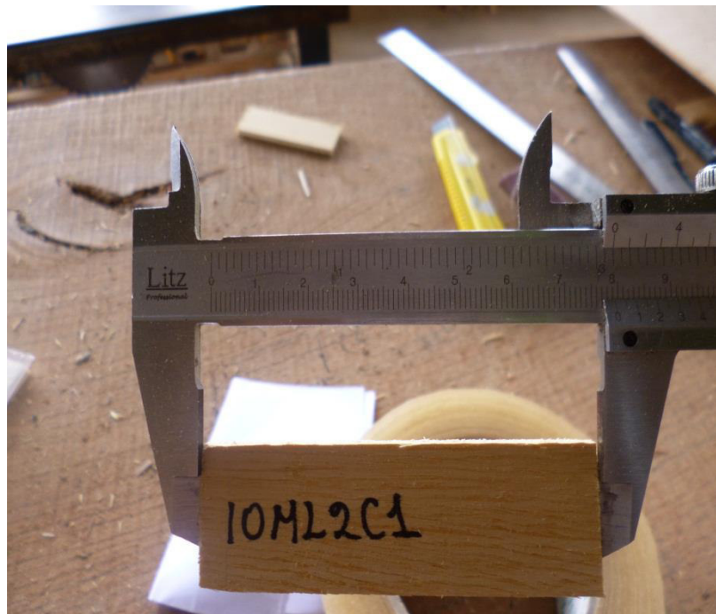
Foto 8: Probetas para el ensayo de cizallamiento
