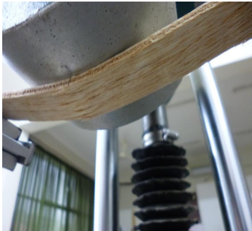
Foto 10: Probetas para el ensayo de flexión estática
