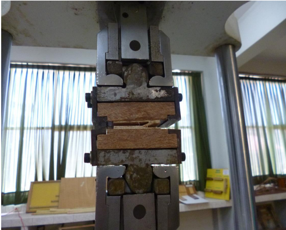
Foto 13: Ensayo de Tracción perpendicular
