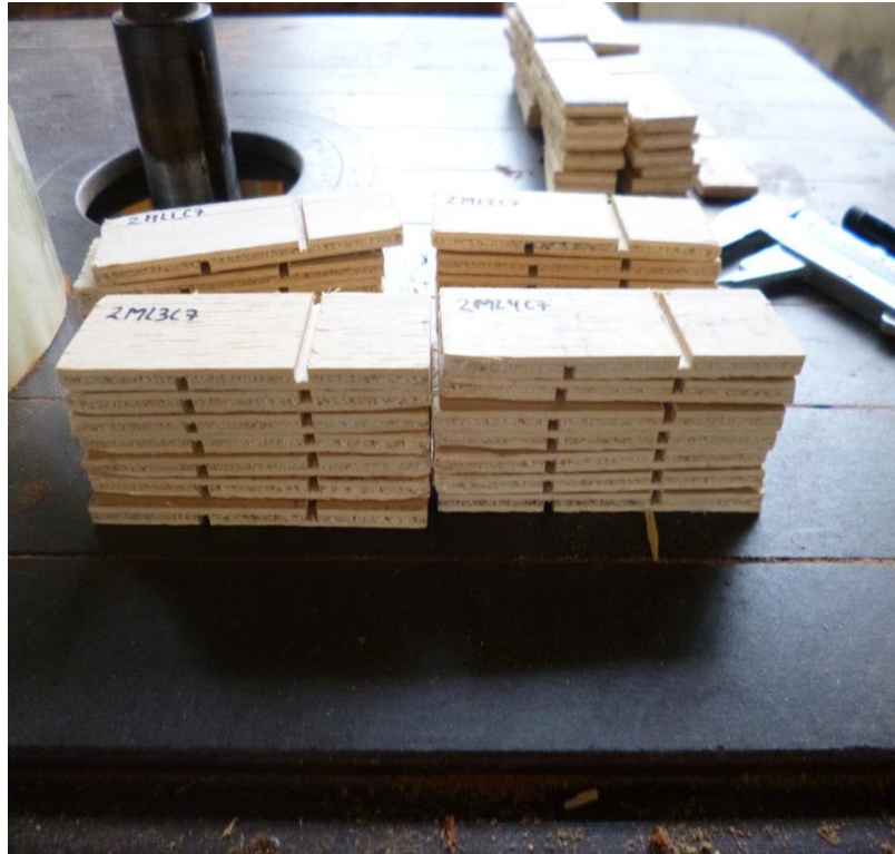
Foto 9: Probetas para el ensayo de cizallamiento
