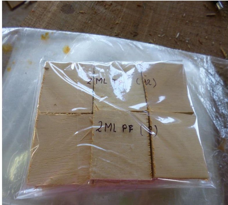
Foto 8: Probetas para el ensayo de cizallamiento
