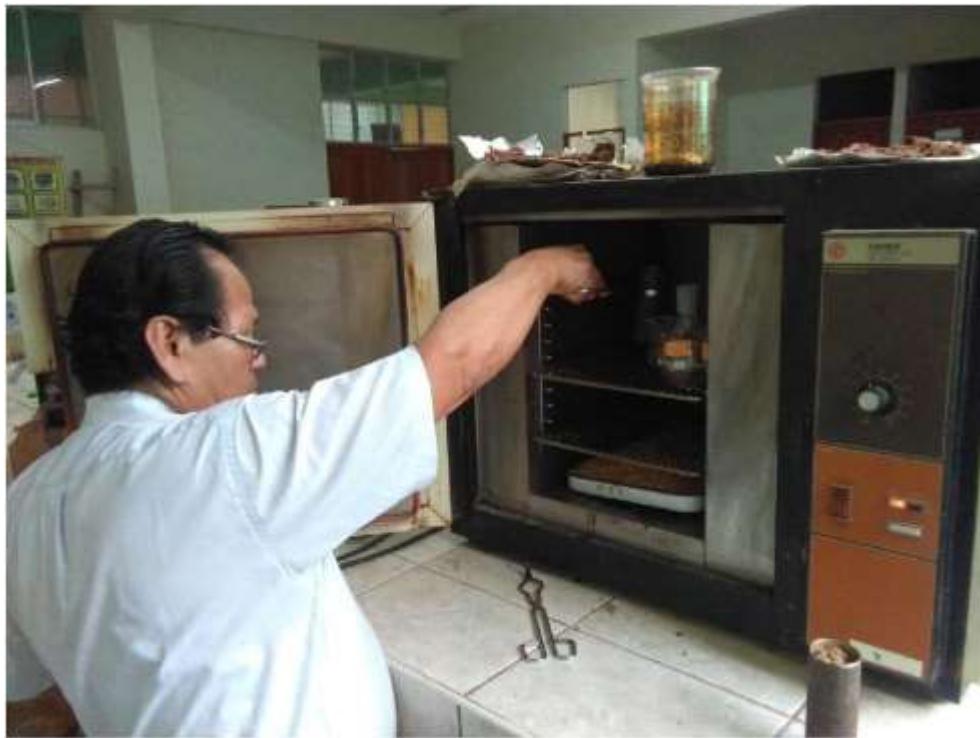
Determinación de la materia orgánica en el laboratorio de suelo de la universidad Nacional de Ucayali
